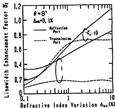
Figure 8. Line Width Augmentation Coefficient<sup>10</sup>
