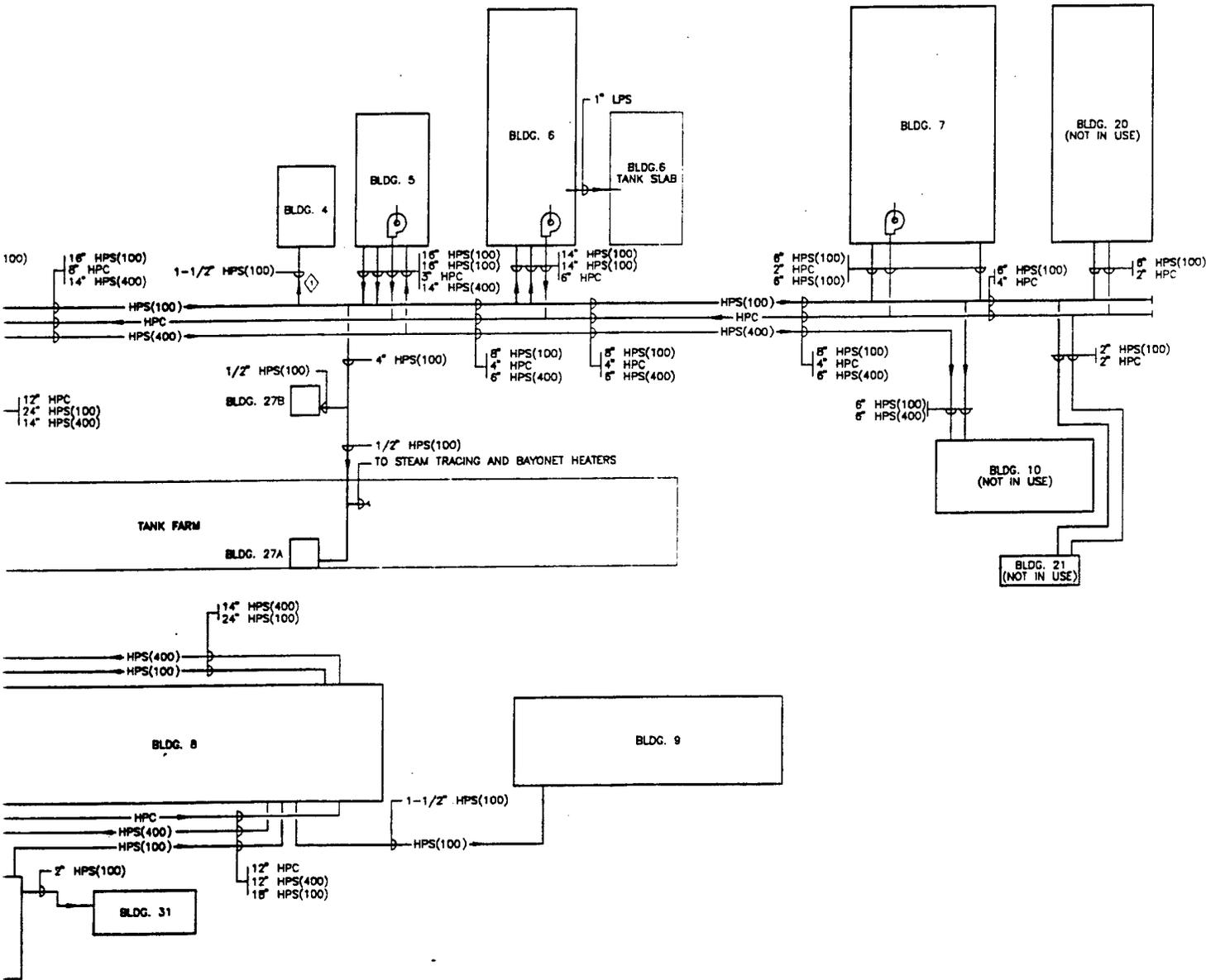
**1 AREA 'A' STEAM & CONDENSATE DISTRIBUTION PIPING DIAGRAM**
