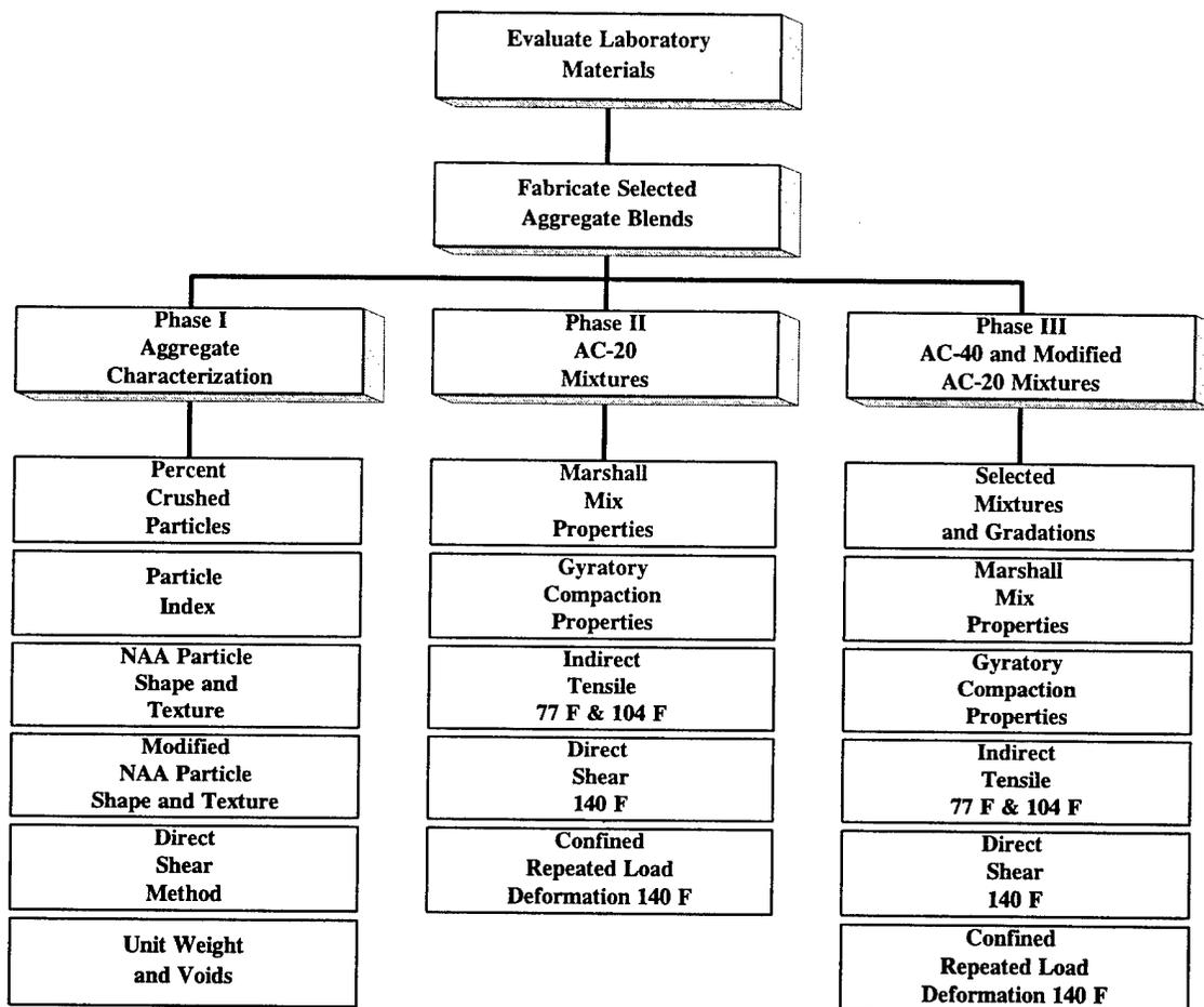
FIGURE 1. MARGINAL AGGREGATE LABORATORY STUDY TEST PLAN
