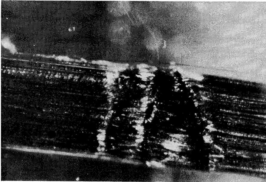
LOCAL BUCKLING OF T300 GRAPHITE BUNDLE IN EPON 815: SIDE VIEW
