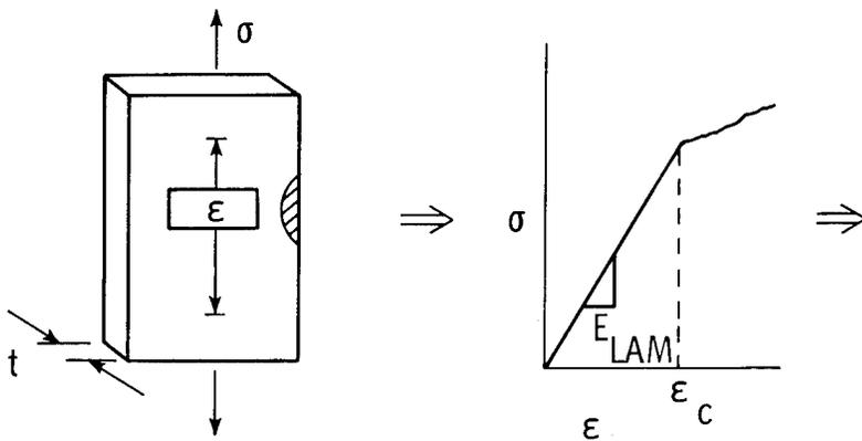
INTERLAMINAR FRACTURE TOUGHNESS
