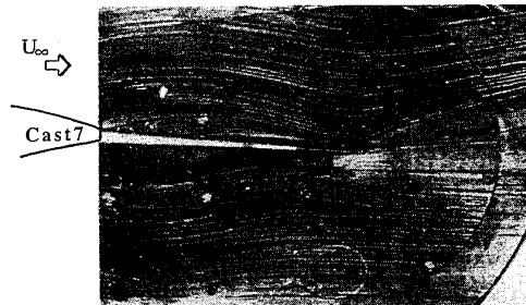
Fig.12 Lignes de frottement calculées (haut) et visualisées expérimentalement (bas)
