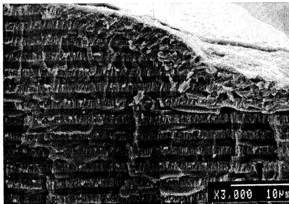
Figure 11 : Fractographie (MEB) du revêtement W/TiB 2 après un essai d'érosion de 25 min sous incidence normale.
