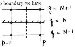
$$\frac{1}{2} \left\{ \frac{u_{N+1}^{p-1} - u_{N-1}^{p-1}}{2} + \frac{u_{N+1}^p - u_{N-1}^p}{2} \right\} + \sqrt{\frac{16jk}{\pi\Delta x_{p-1}}} \frac{u_N^p + u_N^{p-1}}{2} y_\eta$$
