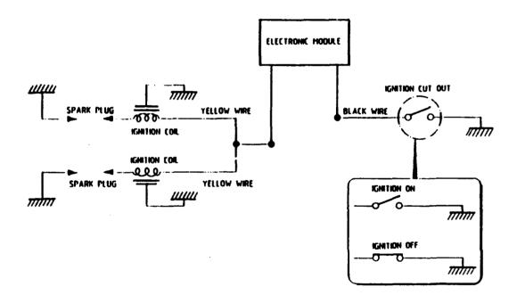
FIGURE 5-2 : IGNITION SYSTEM - CIRCUIT DIAGRAM
