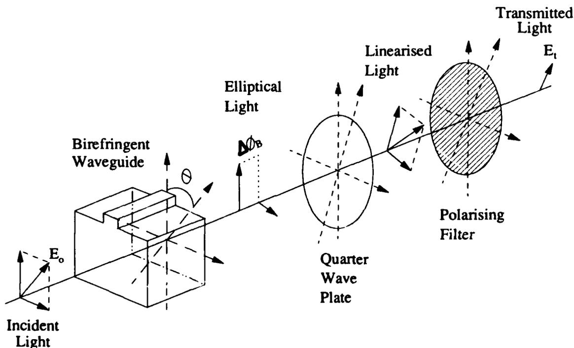
Figure 1 : Birefringent Polarisation Rotation Gate
