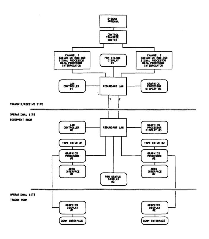
FIGURE 5.2.1.2-1. FLIGHT TEST CONFIGURATION
