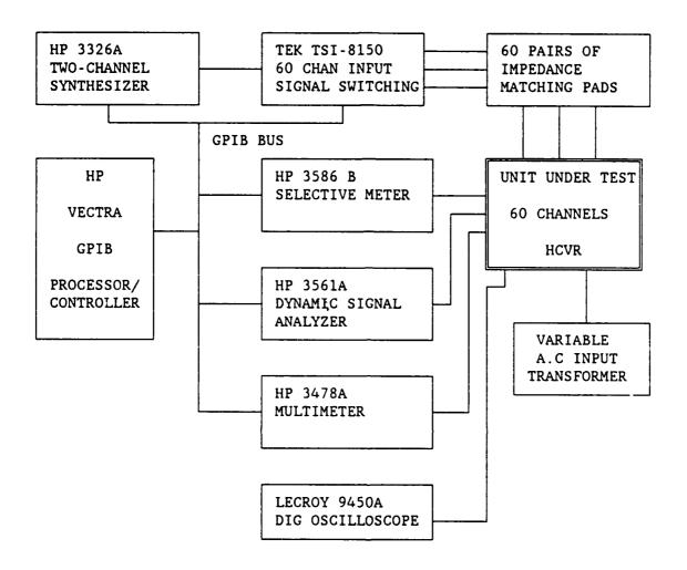
FIGURE 1. UNIT LEVEL TEST CONFIGURATION
