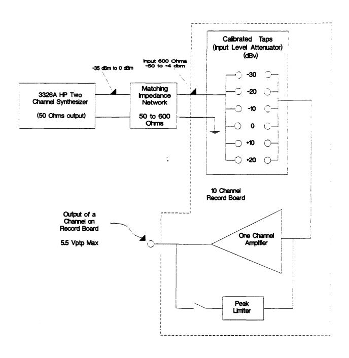
FIGURE 2. AUDIO INPUT LEVEL TEST
