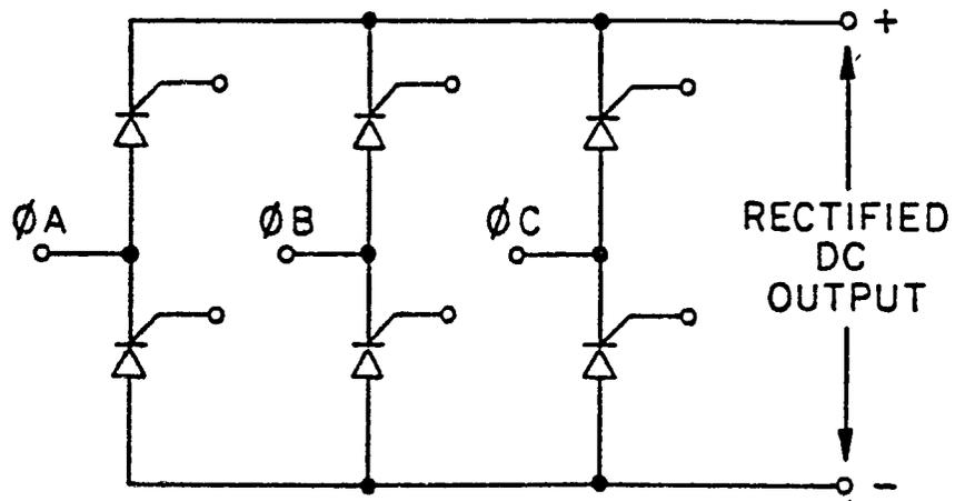
Figure 5-14. Phase Delay Rectifier.
