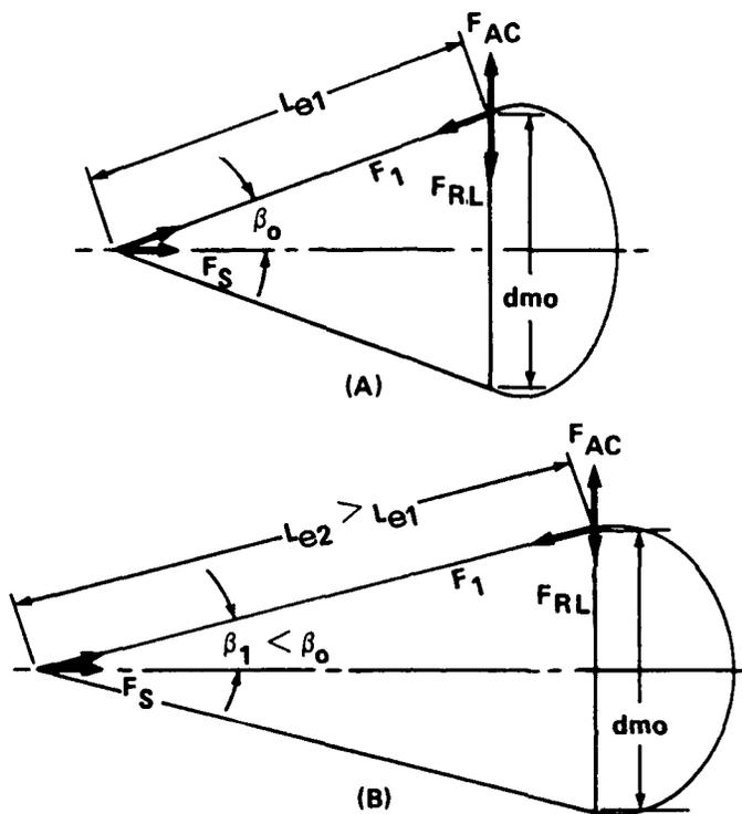
FIGURE 4. EFFECT OF SUSPENSION LINE LENGTH ON THE AERODYNAMIC FORCE BALANCE AT THE SKIRT HEM OF A FLAT TYPE OF PARACHUTE
