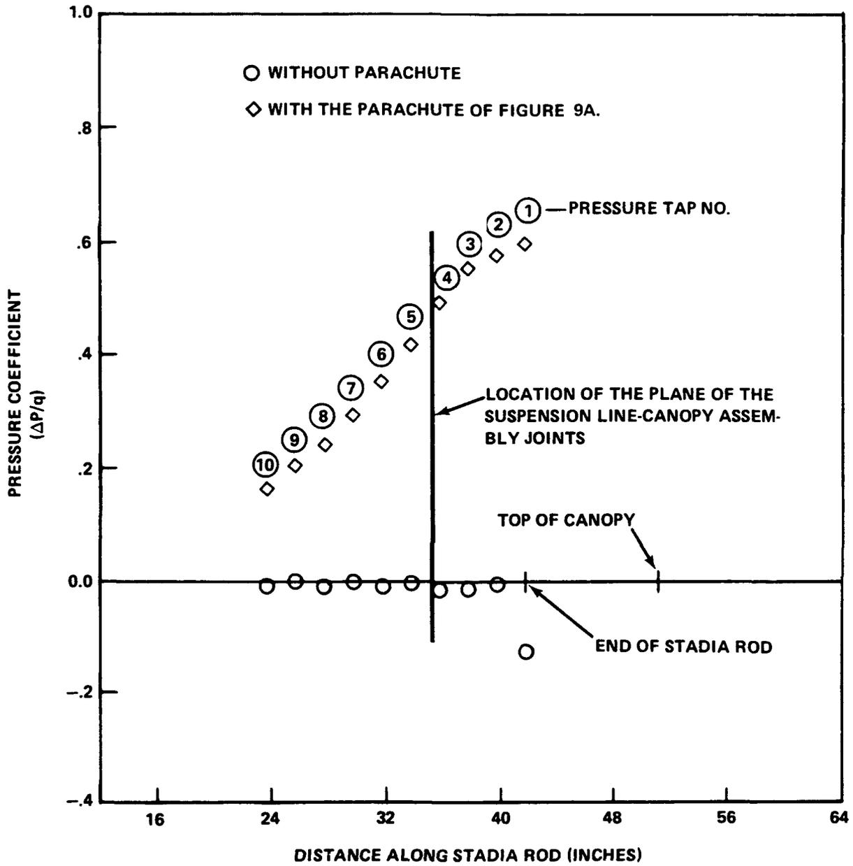
FIGURE 9. MEASURED STATIC PRESSURE DISTRIBUTION ALONG THE STADIA ROD SHOWING ELEVATED LOCAL STATIC PRESSURES AHEAD OF THE CANOPY SKIRT HEM.
