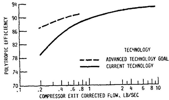
FIGURE 14. - COMPRESSOR EFFICIENCY.
