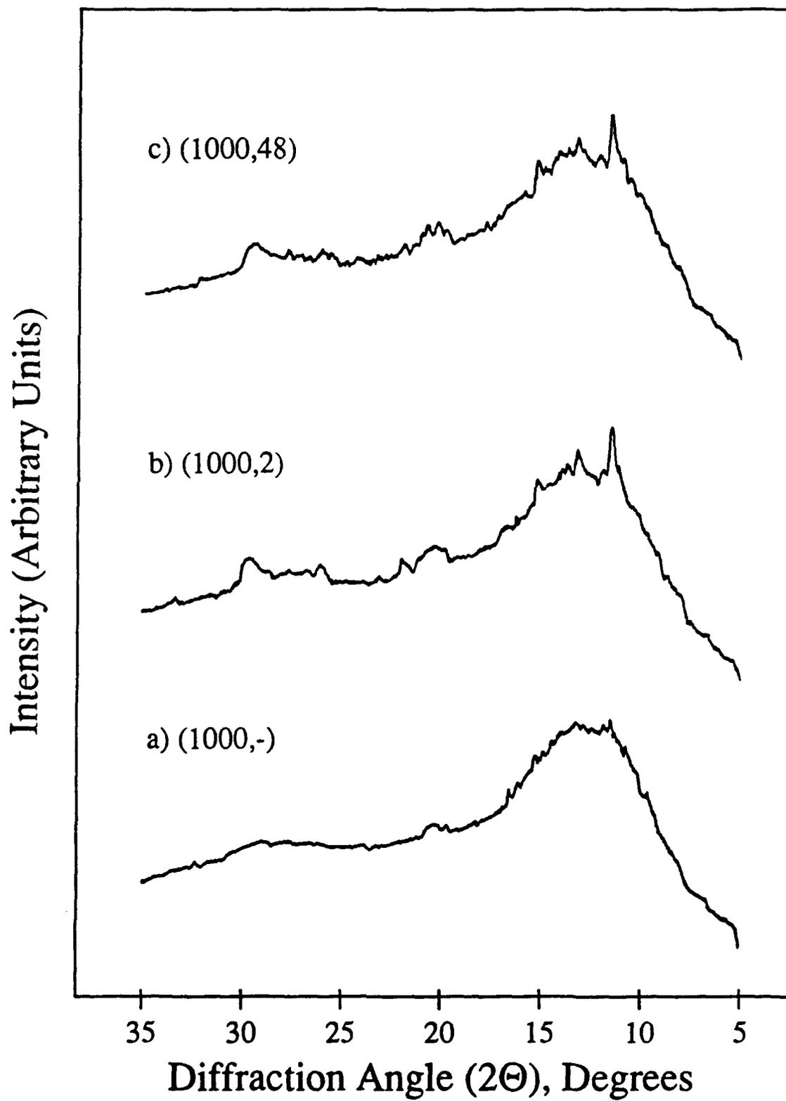
Figure 5-8: XRD OF ALUMINA AEROGEL SUPPORTED NIOBIA AFTER (1000,48): A) A-NA(.05), B) A-NA(.10), AND C) A-NA(.25)
