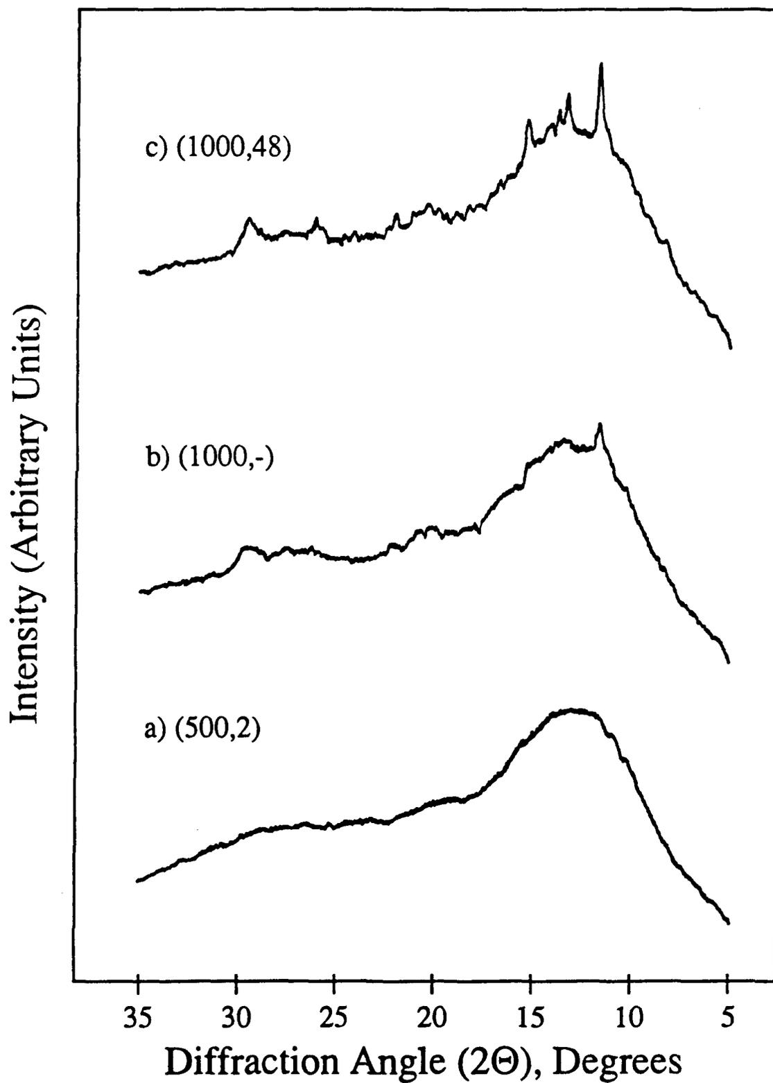
Figure 4-5: XRD OF NA25w AFTER HEAT TREATMENT: A) (500,2), B) (1000,-), AND C) (1000,48)
