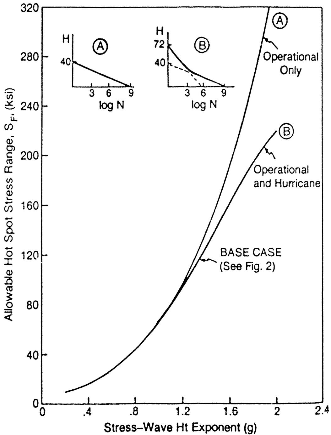
**FIG. 9.9 SENSITIVITY TO WAVE HEIGHT DISTRIBUTION**
