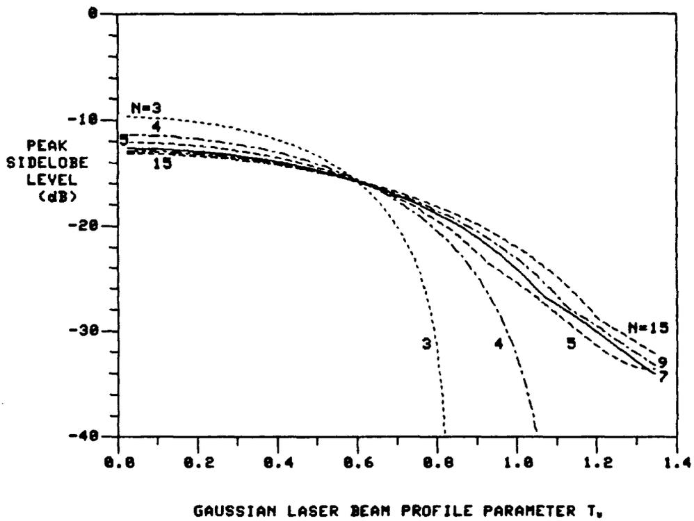
FIGURE 16: PEAK SIDELOBE LEVEL VERSUS  $T_y$  FOR A  $N$ -CHANNEL RECEIVER USING A CIRCULAR ANTENNA ARRAY ( $H/\ell = 0.2$ )
