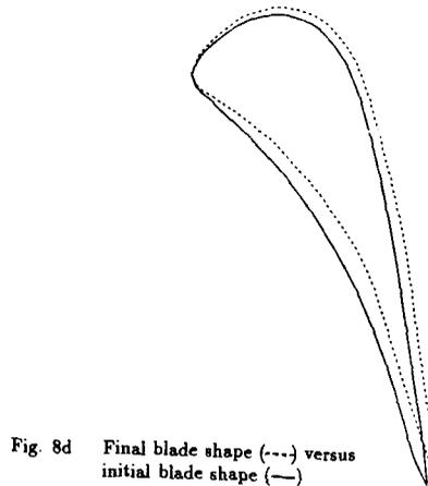
Fig. 8d Final blade shape (---) versus initial blade shape (—)
