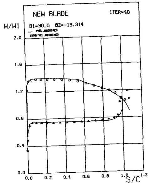
Fig. 4e Final velocity distribution
