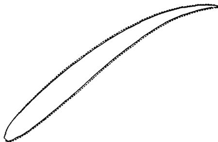
Fig. 7e Final blade shape (---) versus NACA-65 (12A<sub>100</sub>)10 (—)
