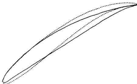
Fig. 7a NACA-65 (12A<sub>100</sub>)10 (---) and NACA-65 (12A<sub>10</sub>)10 (—)
