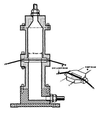
Fig. 3. Dye laser.
