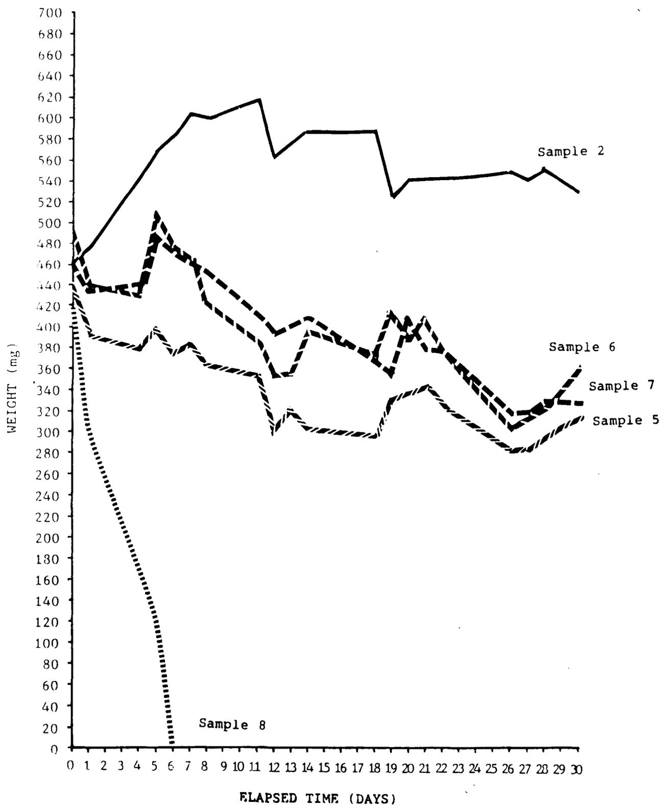
FIGURE 3. DEGRADATION OF GROUP II SAMPLES
