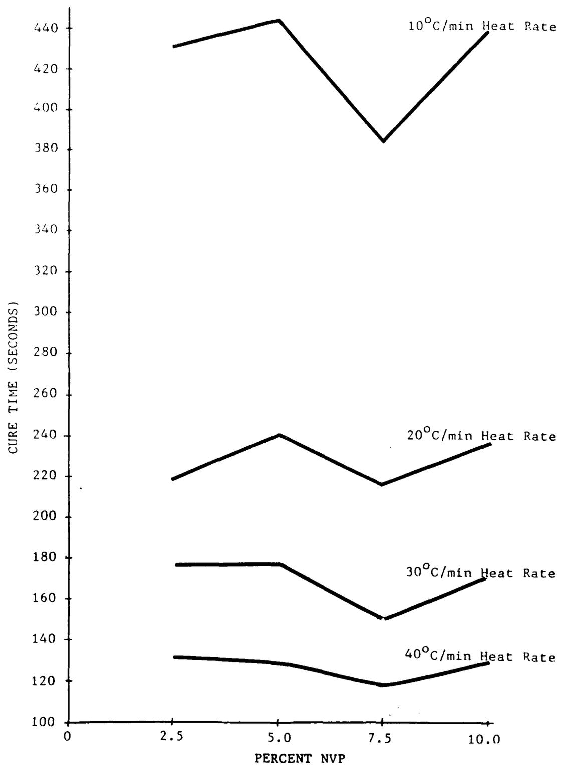
FIGURE 10. CURING TIME OF GROUP III SAMPLES
