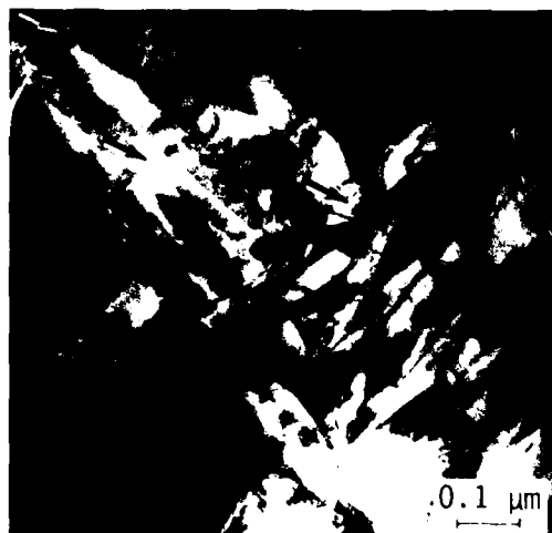
(d) Transformed particles, and associated microcracks (arrows).
