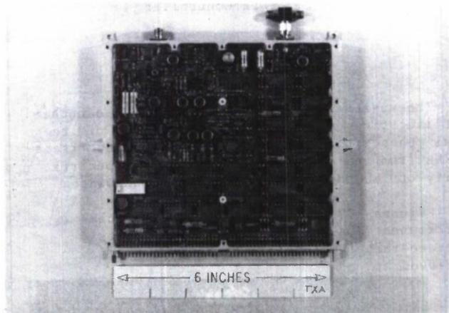
Fig. 16. Loop Filter
