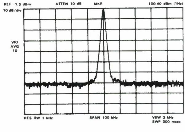
Fig. 20. Synthesizer Phase Noise
