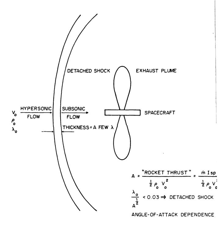
FIGURE 2-4: DETACHED SHOCK IN AMBIENT GAS
