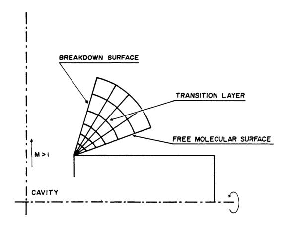
FIGURE 3-2: WEDGE-SHAPE APPROXIMATION TO THE TRANSITION LAYER (CODE SIMUL [2])
