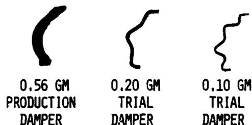
Fig. 4 Test Dampers
