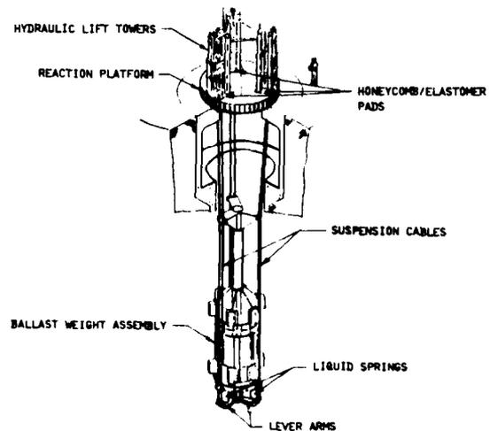
FIGURE 16 VERTICAL DROP TEST OF SHOCK ISOLATION SYSTEM
