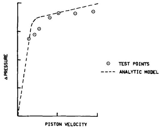
FIGURE 15 COMPRESSION PLCD VALVE STEADY STATE BEHAVIOR
