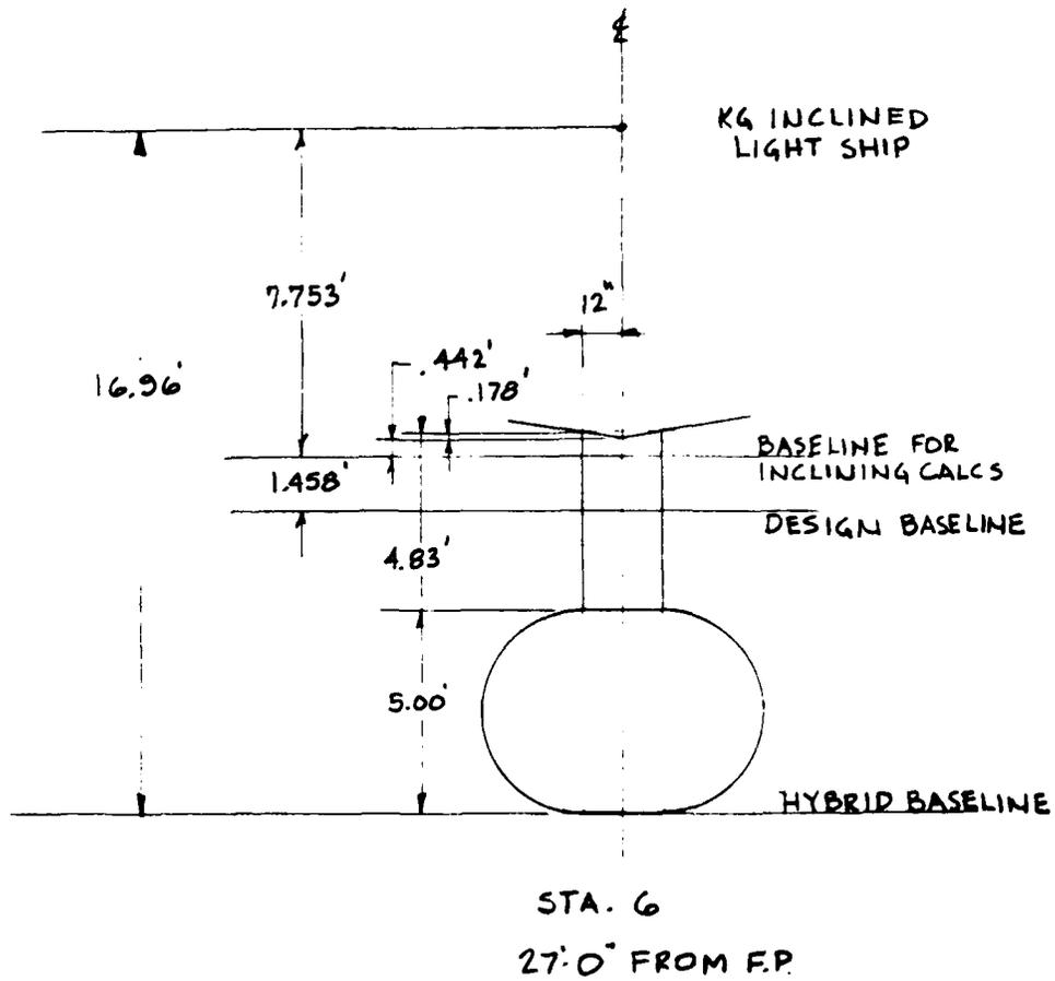
Figure 8-1. KG DERIVATION INCLINED LIGHT SHIP
