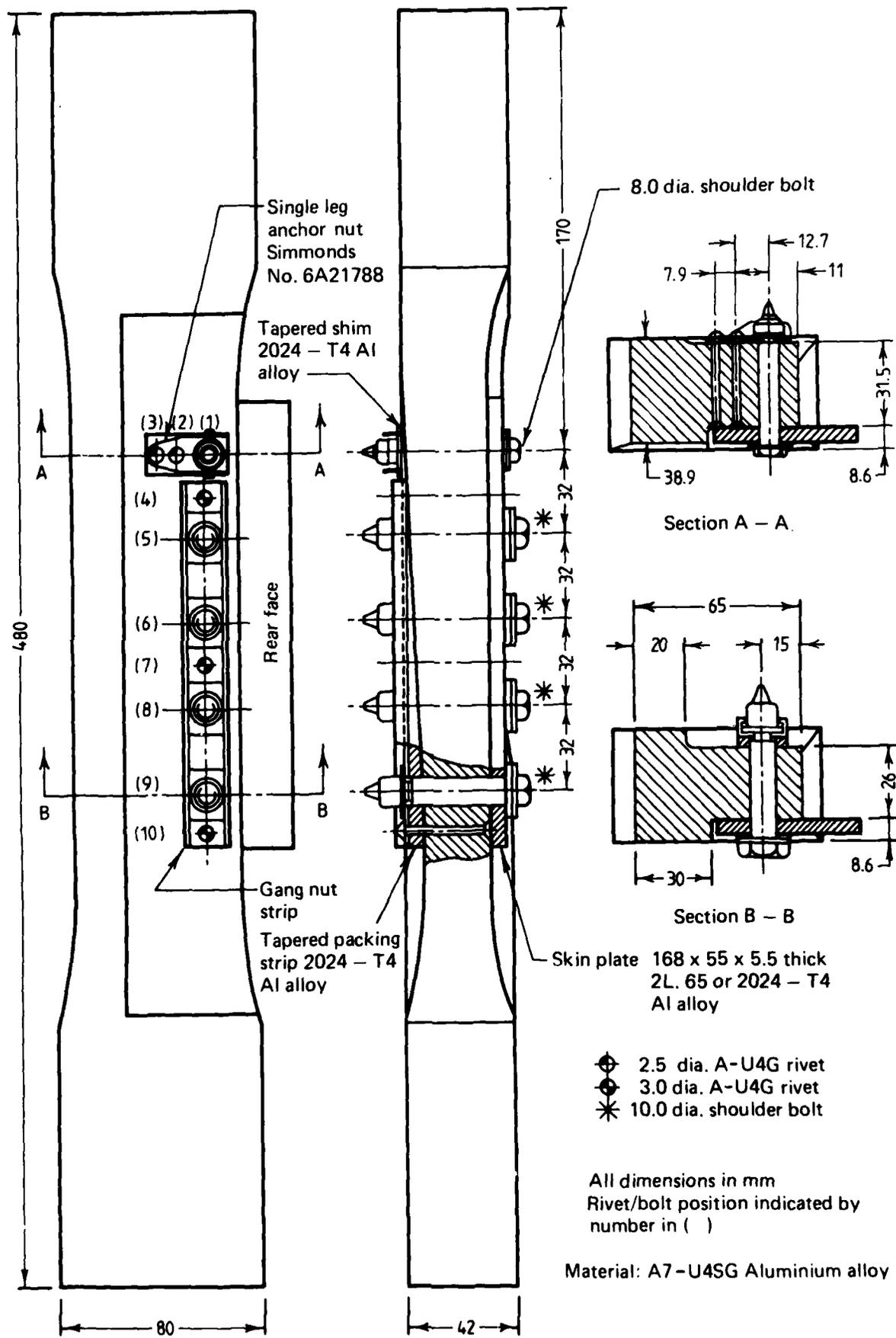
FIG. 4 MIRAGE SPAR LOWER REAR FLANGE FATIGUE SPECIMEN
