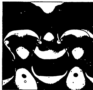
Fig. 15 : Essai photo-élastique de l'attache d'aube
