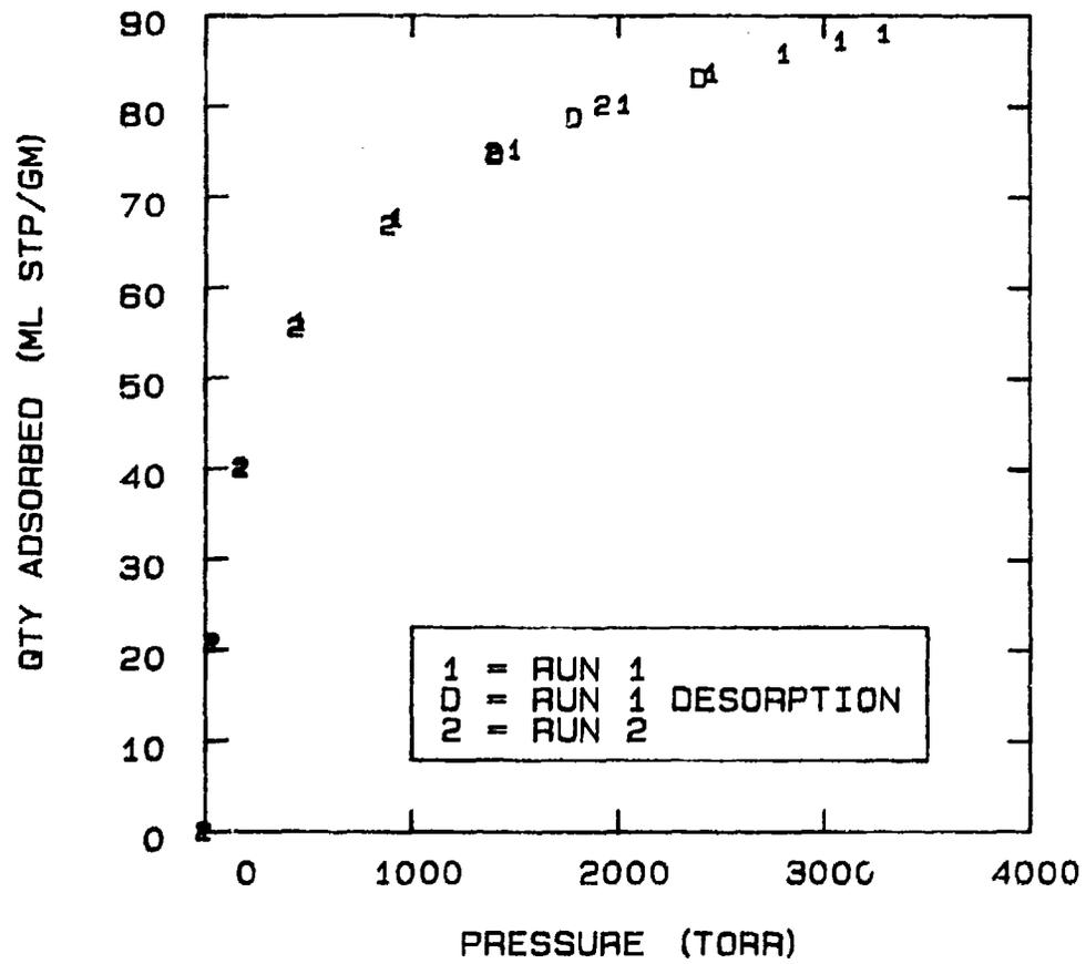
FIG 5-6. NITROGEN ON MOLECULAR SIEVE 5A AT -70°C
