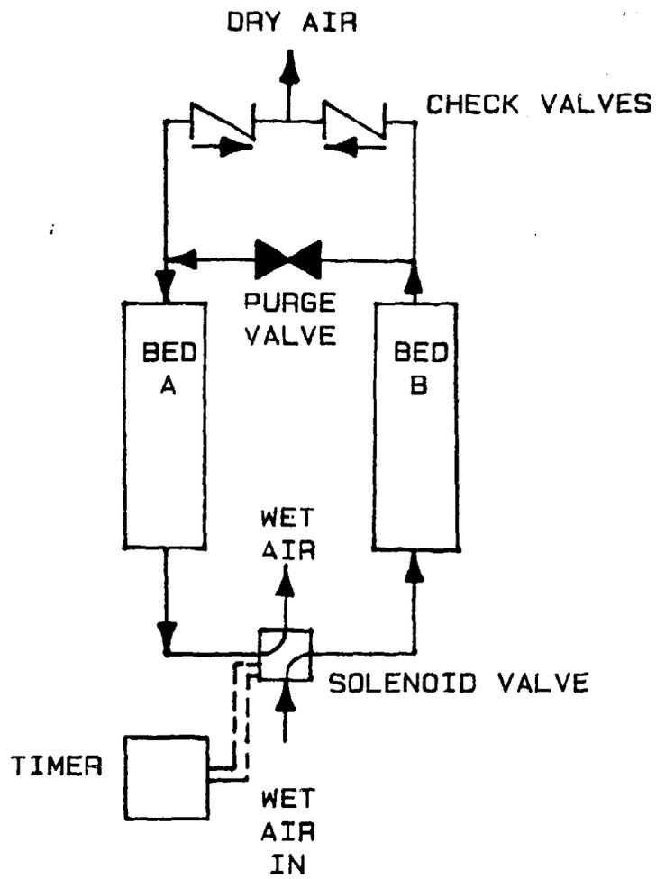
FIG 2-1. SKARSTROM'S HEATLESS ADSORPTION DRYER (27) .
