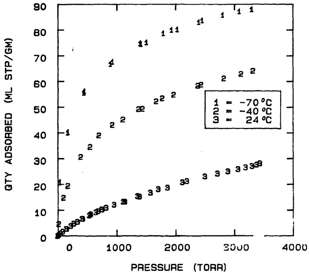
FIG 5-11. NITROGEN ISOTHERMS ON MOLECULAR SIEVE 5A.
