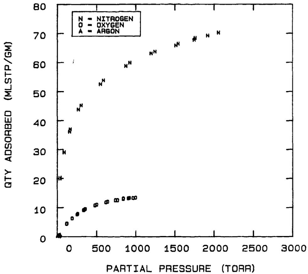
FIG 5-44. MULTICOMPONENT DATA FOR THE SYSTEM AIR-5A AT -70°C.
