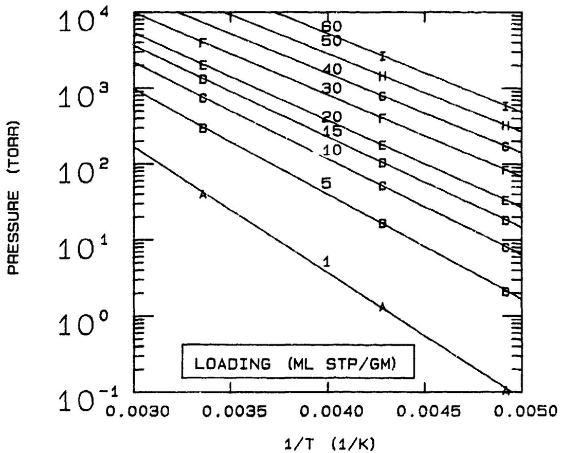
FIG 5-23. ISOTHERMES FOR NITROGEN ON MOLECULAR SIEVE 5A.
