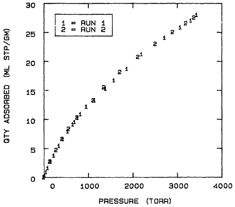
FIG 5-4. NITROGEN ON MOLECULAR SIEVE 5A AT 24°C
