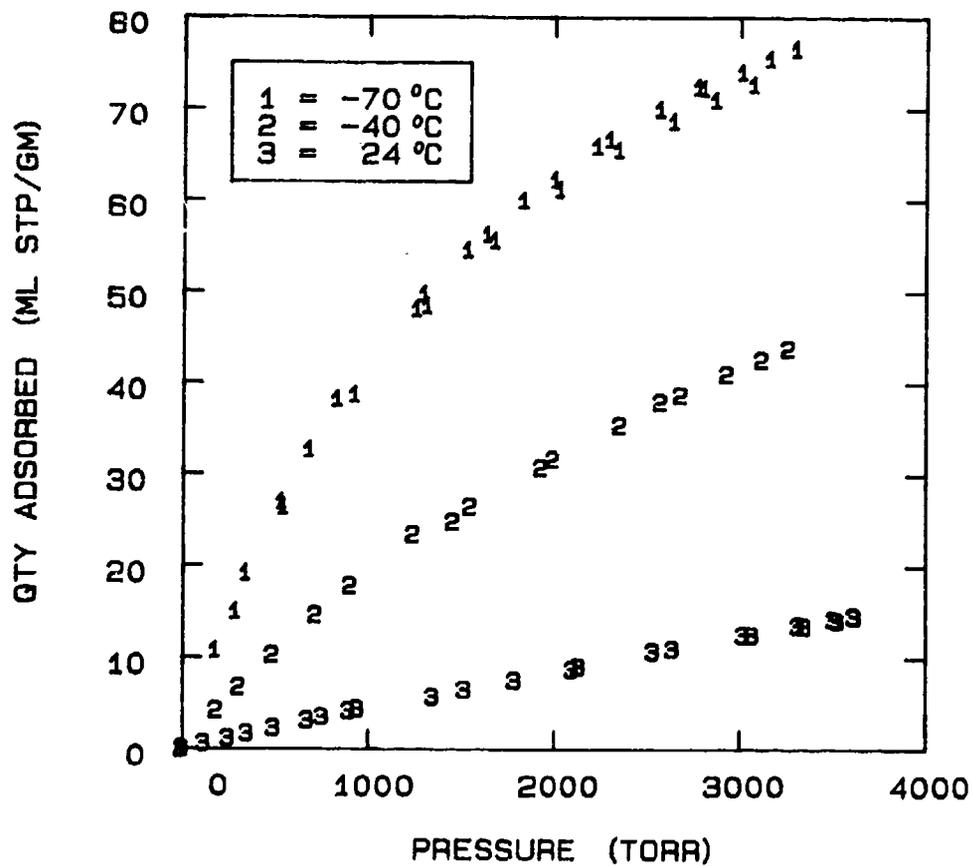
FIG 5-10. OXYGEN ISOTHERMS ON MOLECULAR SIEVE 5A.
