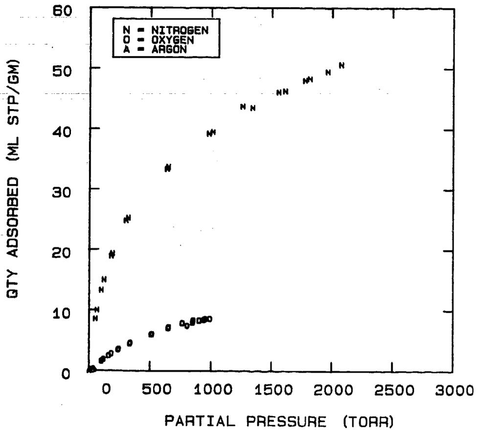
FIG 5-43. MULTICOMPONENT DATA FOR THE SYSTEM AIR-5A AT -40 °C.
