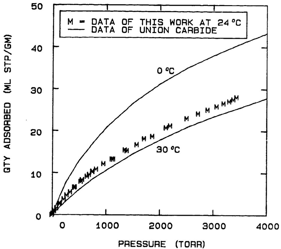
FIG 5-15. NITROGEN ISOTHERM ON MOLECULAR SIEVE 5A AT 24°C SHOWN WITH DATA OF UNION CARBIDE.
