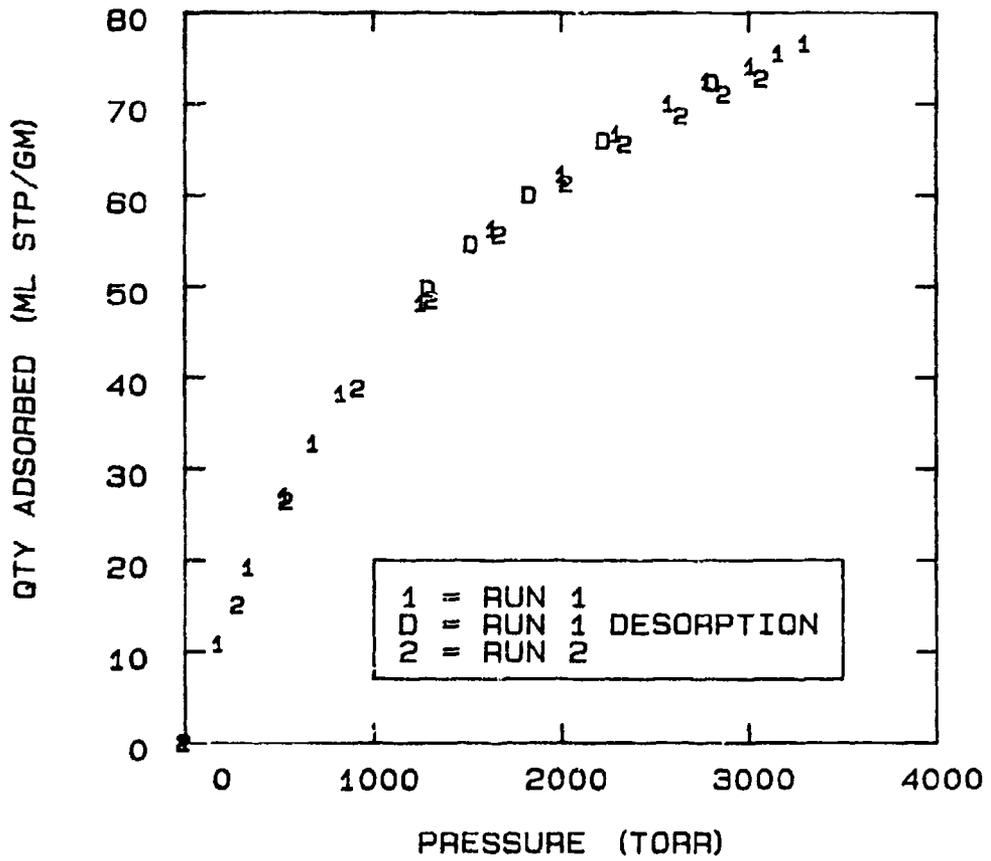
FIG 5-3. OXYGEN ON MOLECULAR SIEVE 5A AT -70°C
