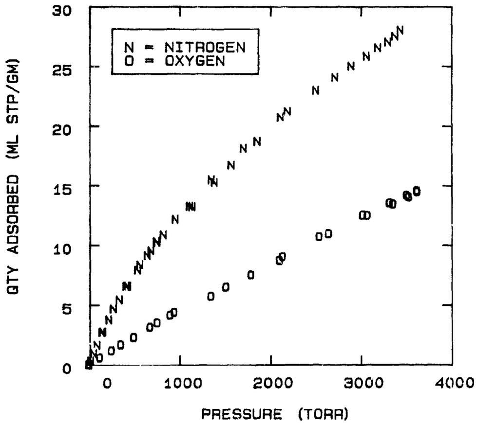
FIG 5-7. PURE NITROGEN AND OXYGEN ON MOLECULAR SIEVE 5A AT 24°C.
