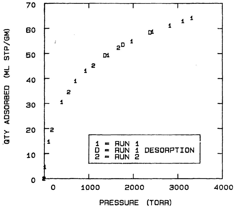
FIG 5-5. NITROGEN ON MOLECULAR SIEVE 5A AT -40°C
