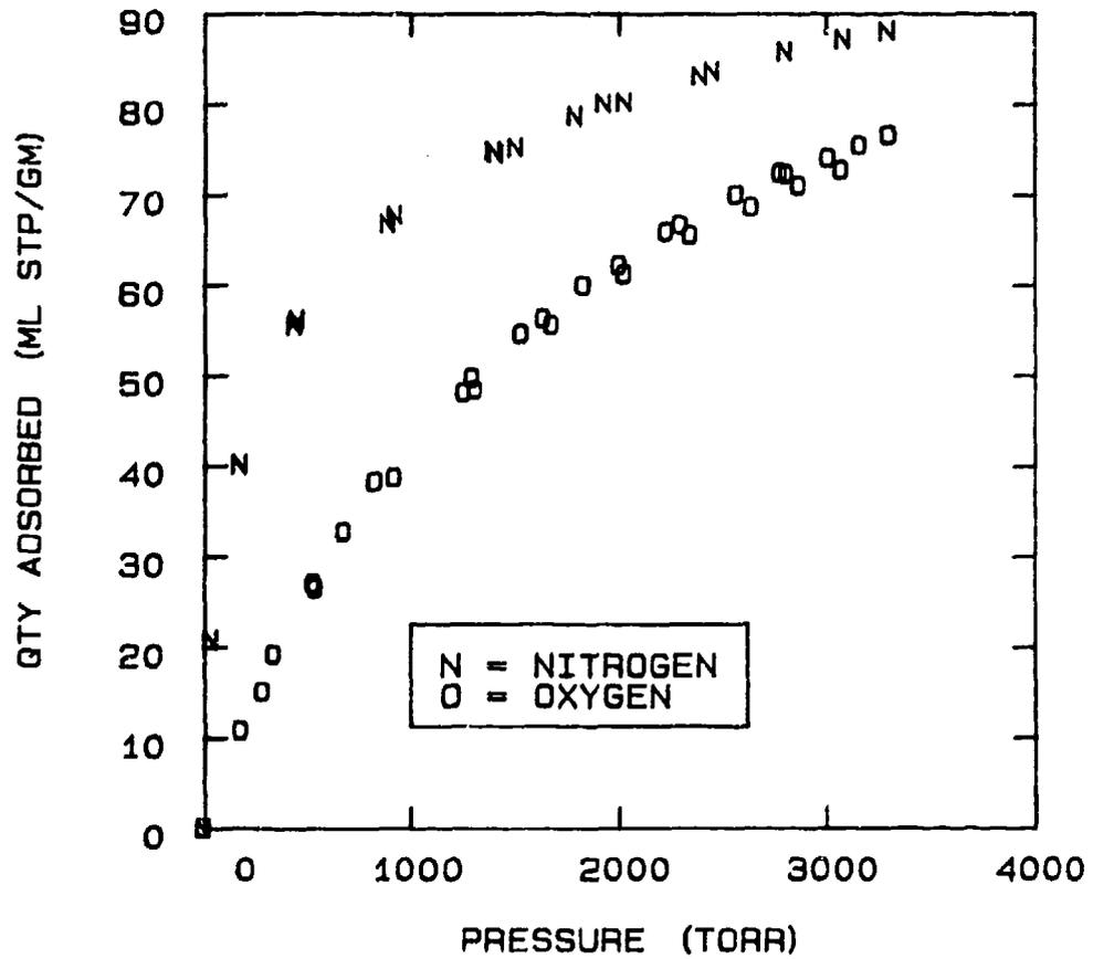
FIG 5-9. PURE NITROGEN AND OXYGEN ON MOLECULAR SIEVE 5A AT  $-70^{\circ}\text{C}$ .
