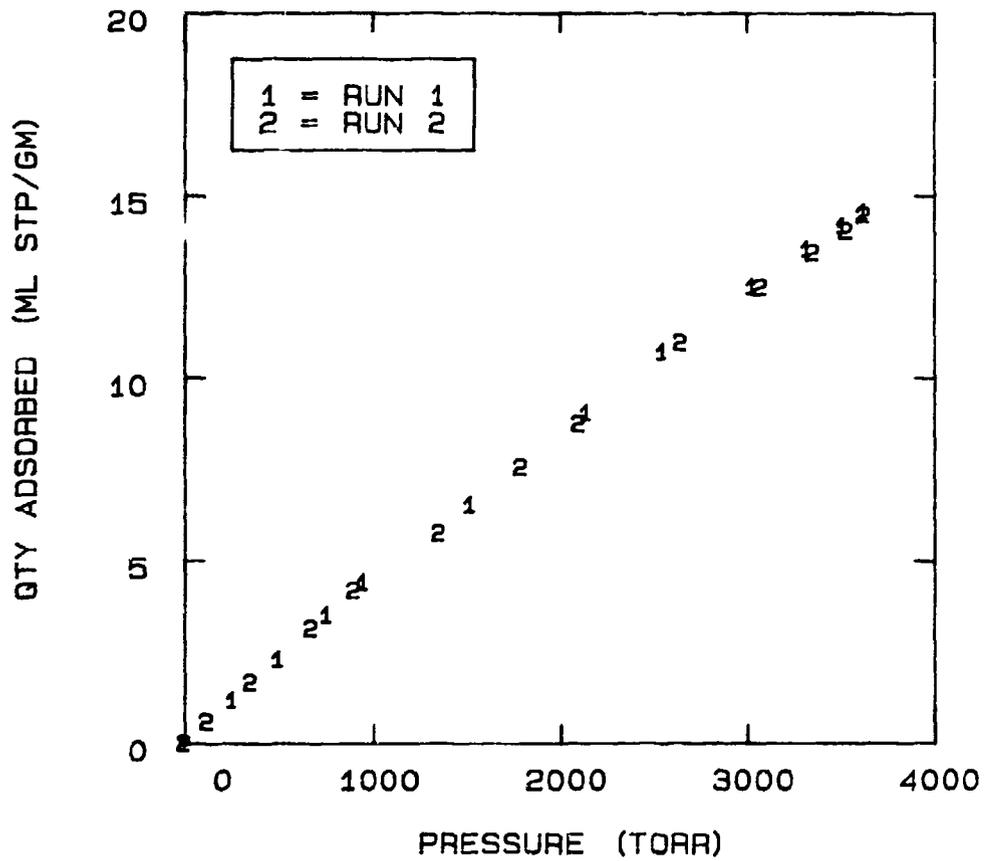
FIG 5-1. OXYGEN ON MOLECULAR SIEVE 5A AT 24°C
