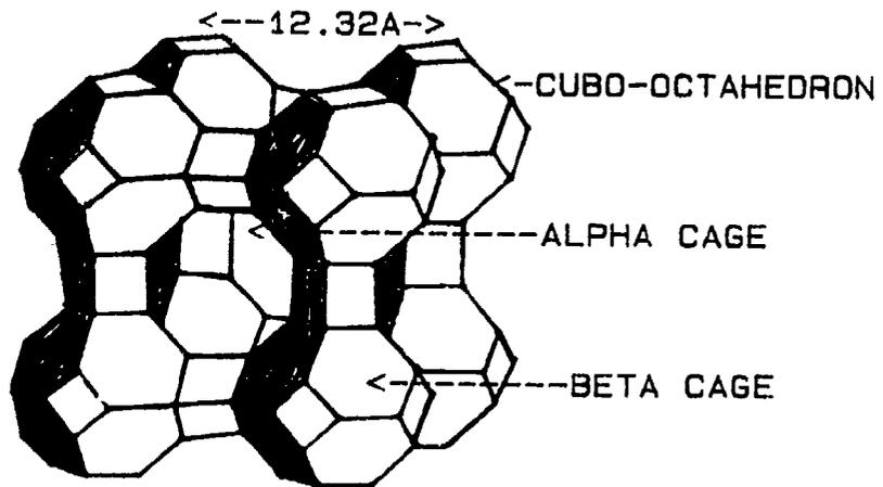
FIG 3-1. STRUCTURAL MODEL OF MOLECULAR SIEVE 5A.
