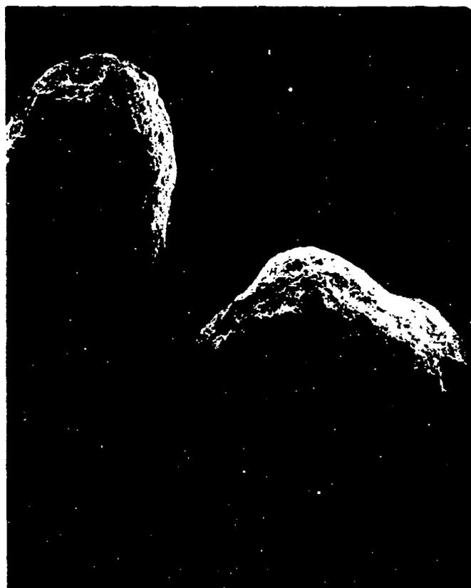
FIG 4-2. ELECTRON MICROGRAPH OF MOLECULAR SIEVE 5A
