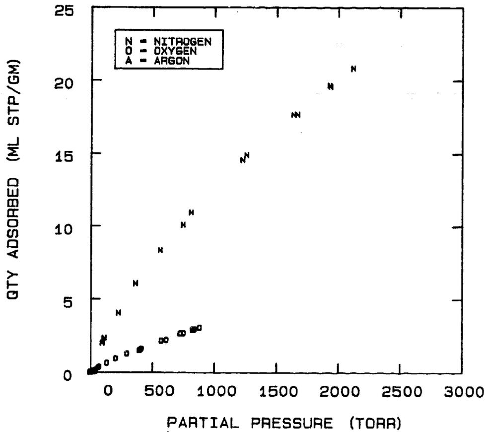
FIG 5-42. MULTICOMPONENT DATA FOR THE SYSTEM AIR-5A AT 24°C.
