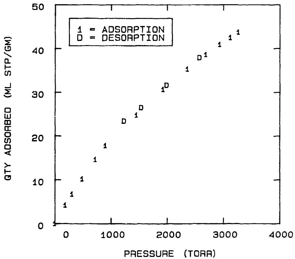
FIG 5-2. OXYGEN ON MOLECULAR SIEVE 5A AT -40°C
