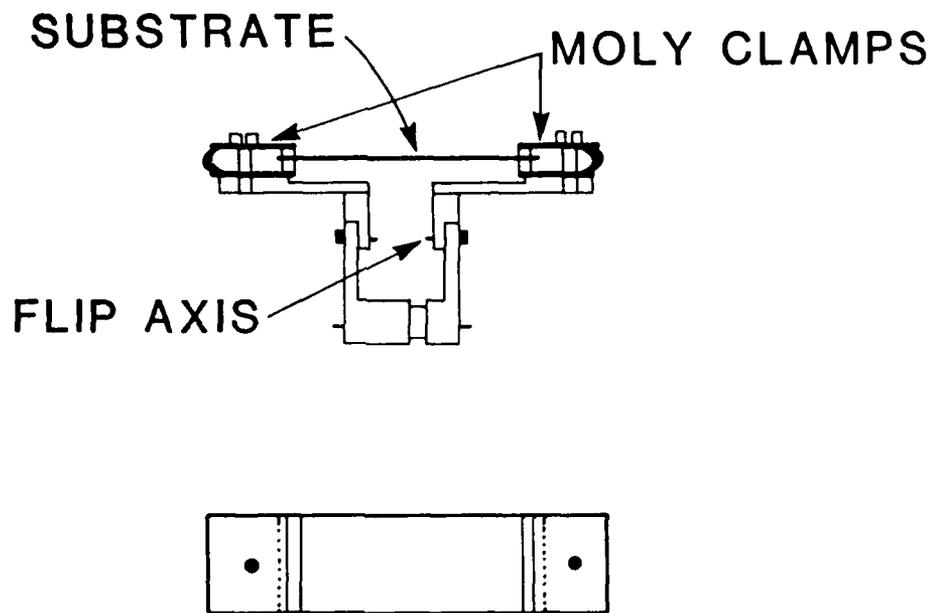
Fig. 5 SILICON SAMPLE HOLDER FOR RESISTIVE HEATING
