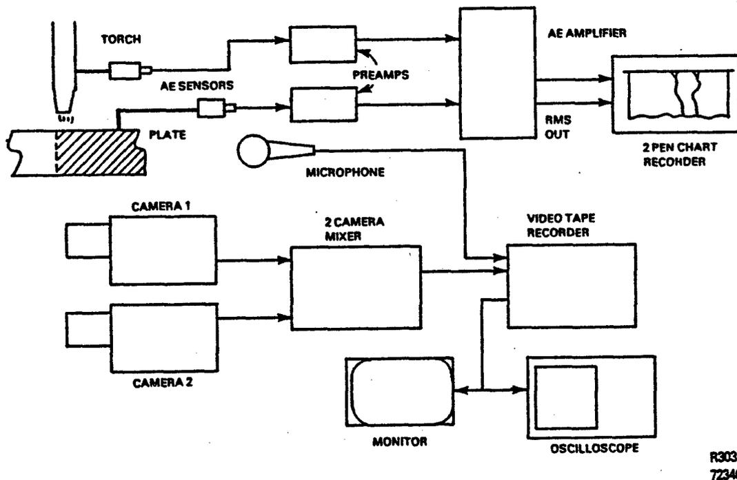
FIGURE 5-2. BLOCK DIAGRAM OF INSTRUMENTATION USED TO MONITOR FLAME CUTTING PROCESS
