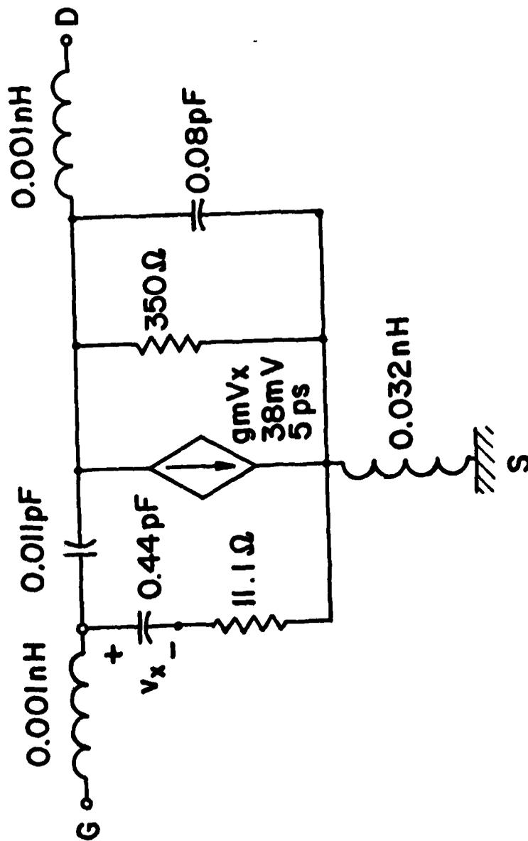
OPTIMIZED MODEL FOR TI -  $300\mu$  GaAs MESFET.
