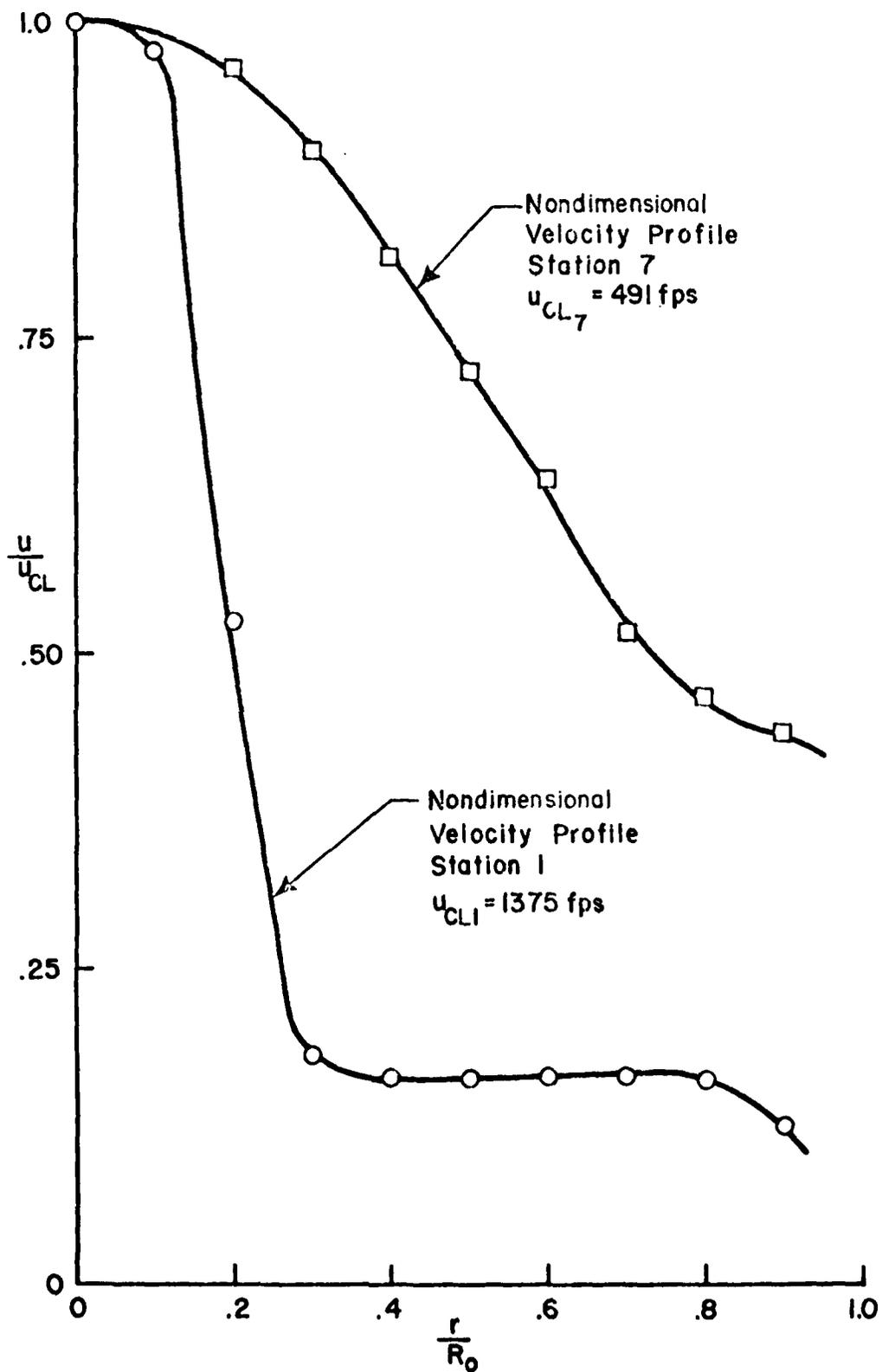
FIGURE 17 NONDIMENSIONAL VELOCITY PROFILES,  $P_{T1} = 2.1$  atm
