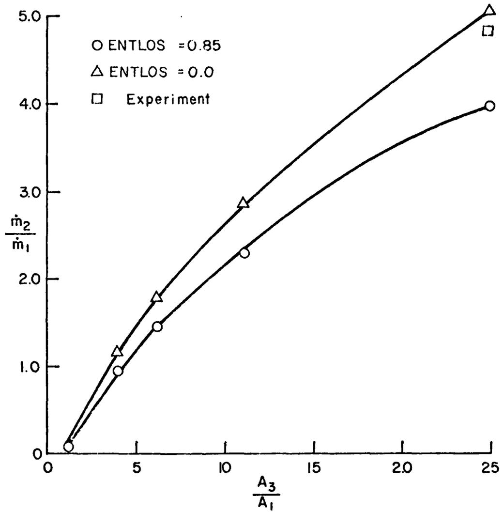
FIGURE 23 AUGMENTATION RATIO VS  $A_3/A_1$ ,  $P_{T_1} = 1.6$  atm
