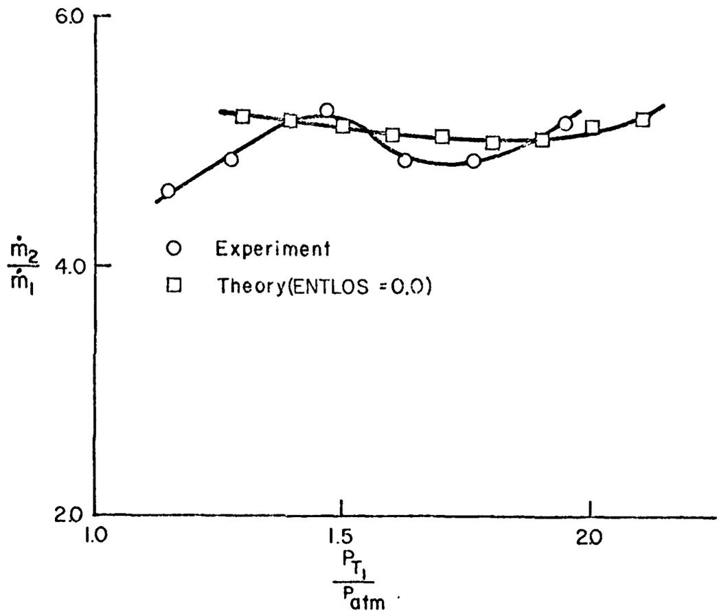
FIGURE 20 VARIATION OF AUGMENTATION RATIO WITH  $P_{T1}$ , CONFIGURATION 200.13
