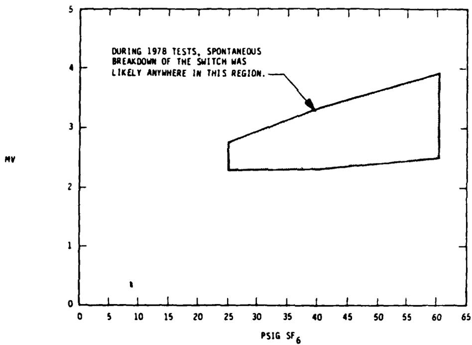
FIGURE 10 DQ SWITCH SELF-BREAK MODE OPERATING RANGE JULY 1978
