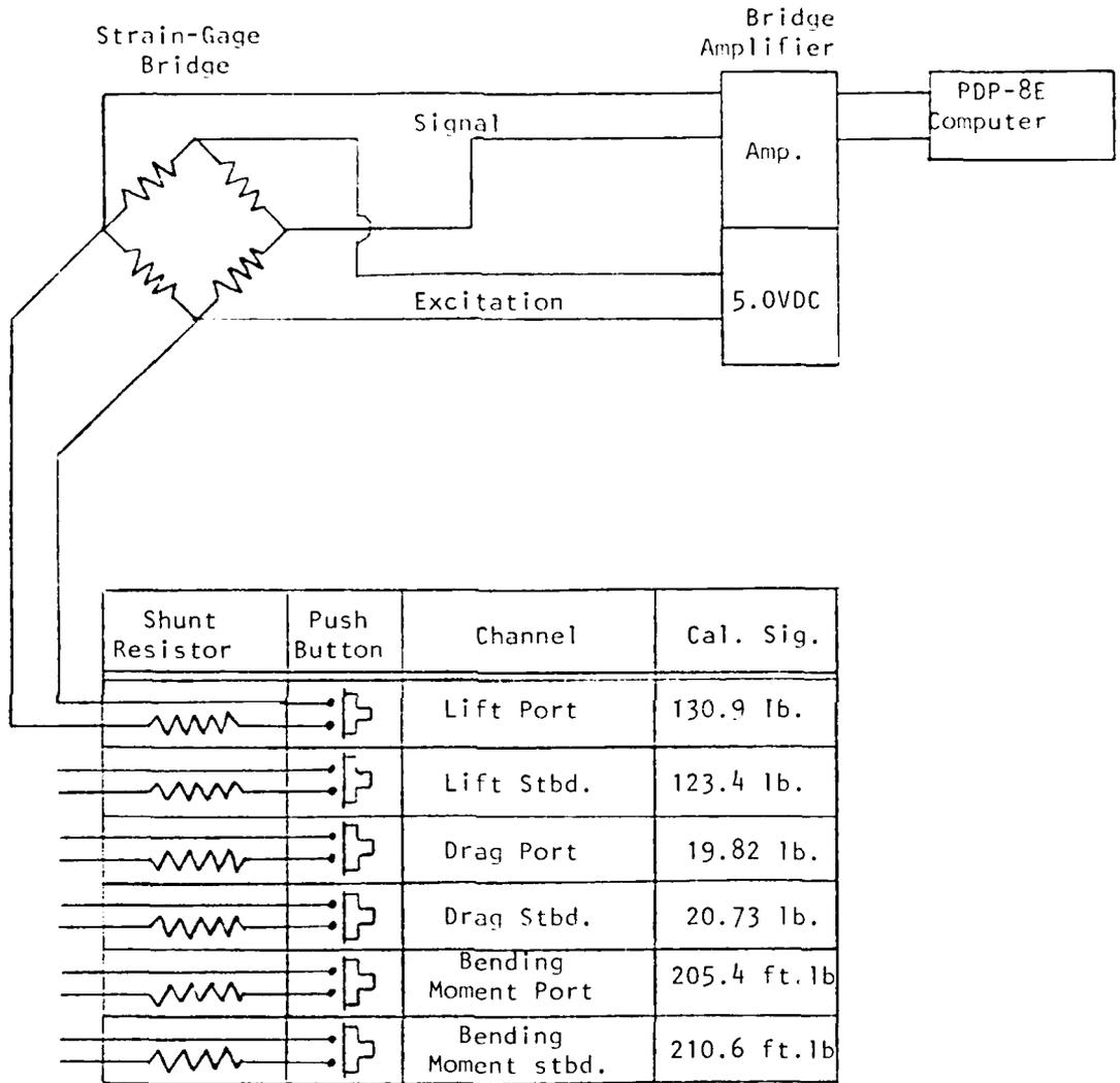
FIGURE 5 STRAIN-GAGE SCHEMATIC
