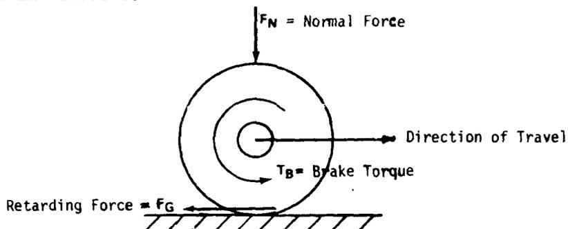
FIGURE 3 RELATIONSHIP OF FORCES ON A BRAKED WHEEL/TIRE
