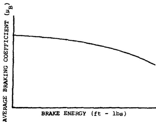
FIGURE 13 AVERAGE BRAKING COEFFICIENT VS BRAKE ENERGY
