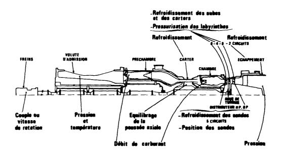
Key: Refroidissement des aubes et des Pressurisation des labyrinthes Freins Volute d'admission Prechambre Refroidissement Carter Chambre Echappement Pression Roue de turbine Distributeur HP, BP Refroidissement des sondes Position des sondes Equilibrage de la poussée axiale Pression et température Couple ou vitesse de rotation Débit de carburant
