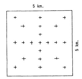
FIGURE 3 - NOMINAL PLAN POSITION OF CONTROL POINTS IN THE DTM
