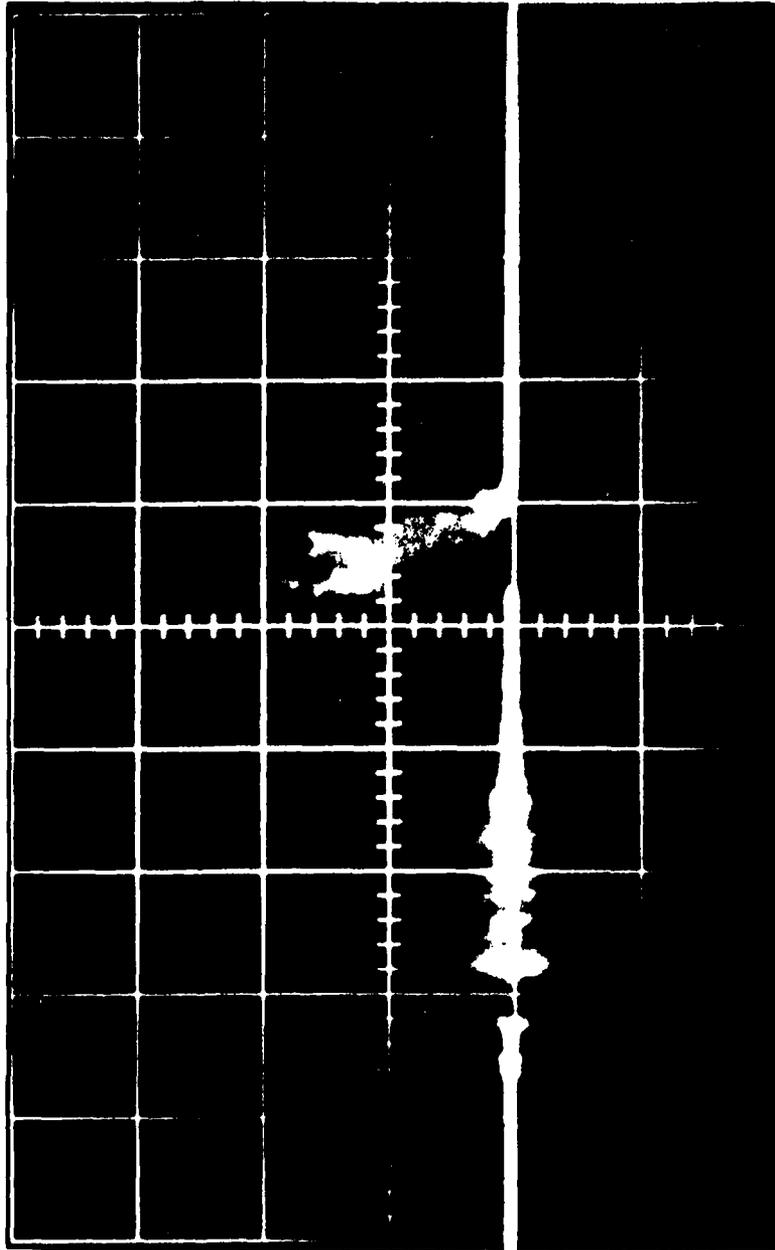
**CH<sub>3</sub>Cl PULSED OUTPUT AT 944 μm**
