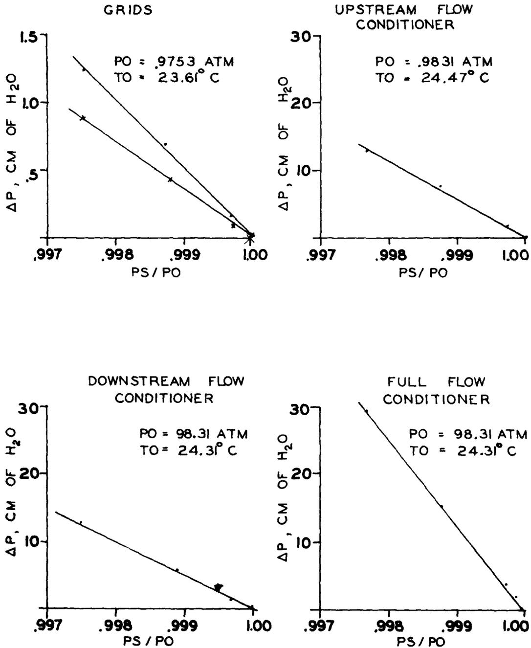
FIGURE 19b TEST CONFIGURATION PRESSURE DROP AS A FUNCTION OF UPSTREAM PS/PO
