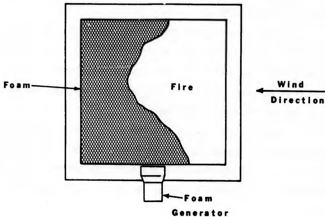
FIGURE 33. PLAN VIEW OF FIRE PIT SHOWING THE EFFECT OF CROSSWINDS ON HIGH EXPANSION FOAM DISTRIBUTION.
