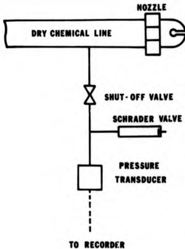
FIGURE 17. DRY CHEMICAL NOZZLE PRESSURE MONITORING SYSTEM.
