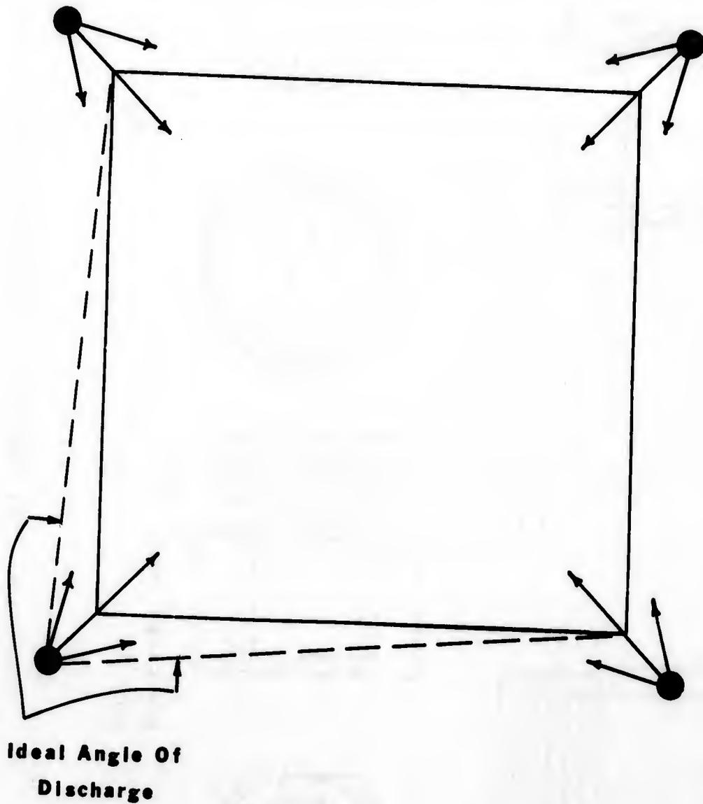
FIGURE C-3. ORIGINAL PLACEMENT OF DRY CHEMICAL DISCHARGE NOZZLES.
