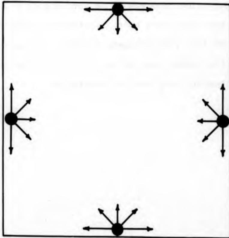
FIGURE C-6. FINAL CHOICE OF LOCATIONS FOR DRY CHEMICAL DISCHARGE NOZZLES.
