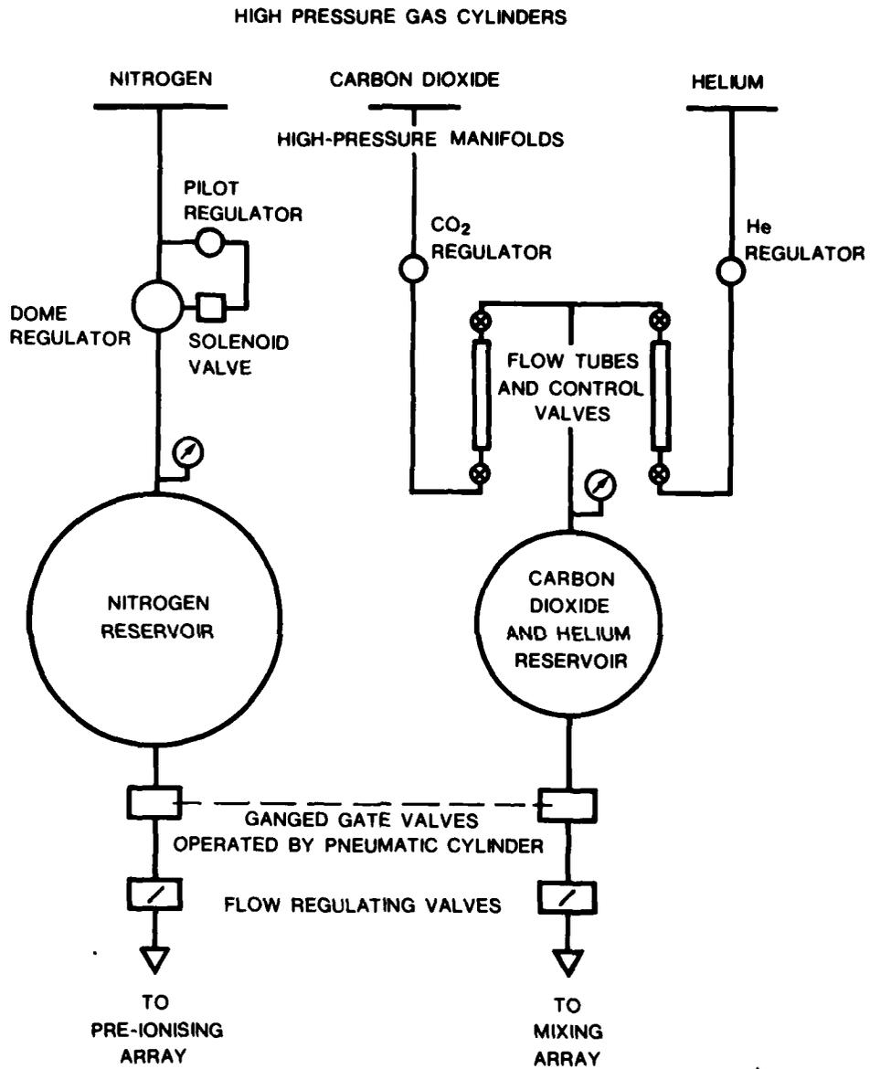
FIG. 7 - SCHEMATIC DIAGRAM OF GAS SYSTEM.
