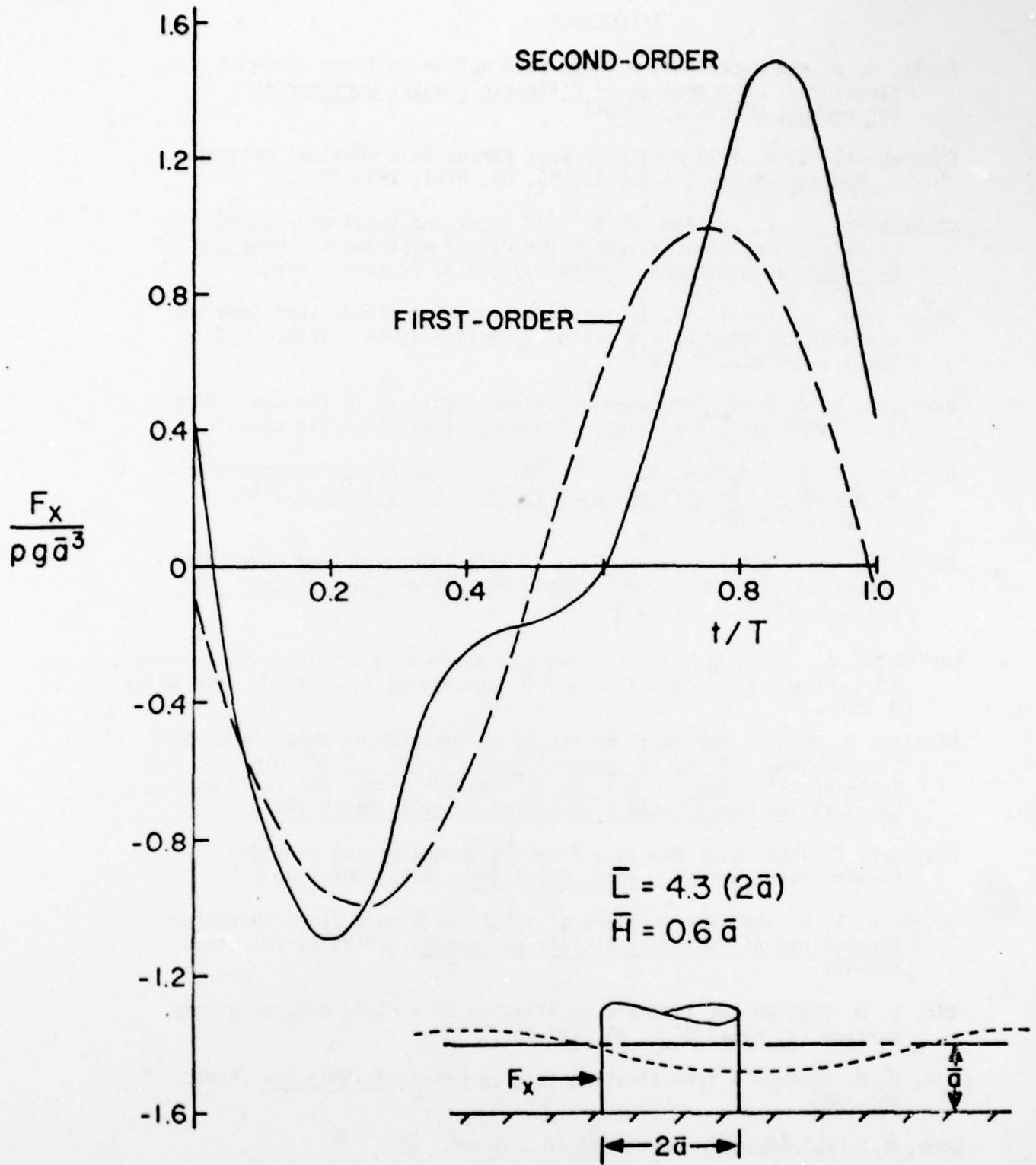
FIGURE 5 HORIZONTAL WAVE FORCE ON A VERTICAL CYLINDER
