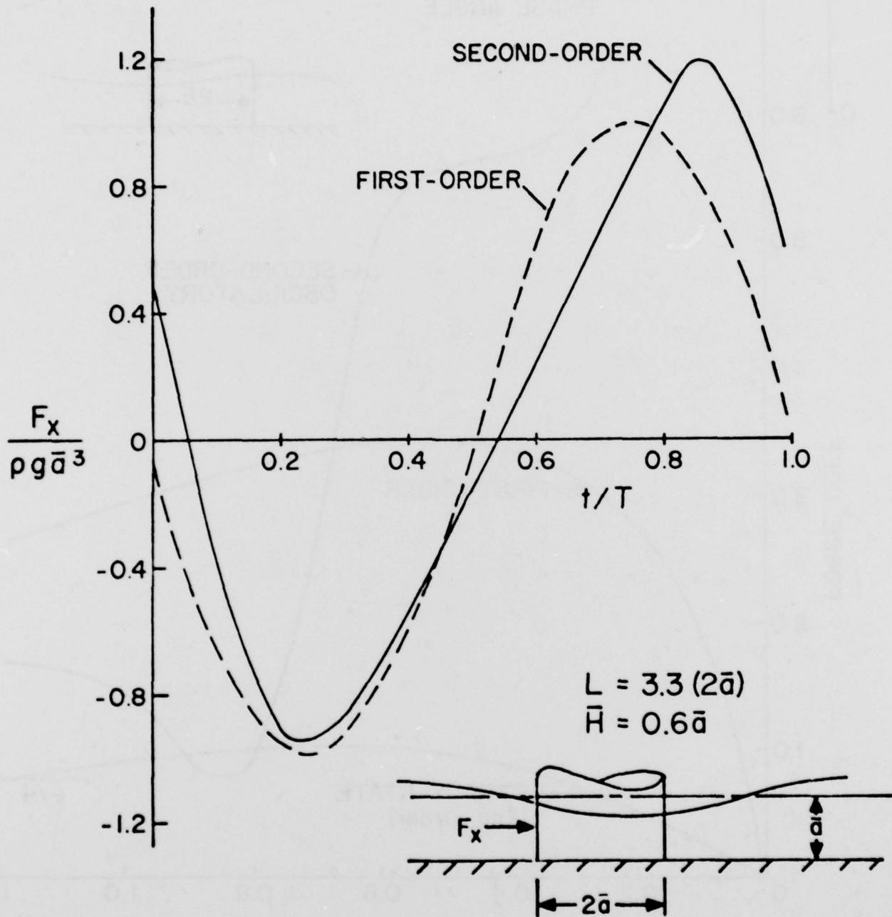
FIGURE 4 HORIZONTAL WAVE FORCE ON A VERTICAL CYLINDER
