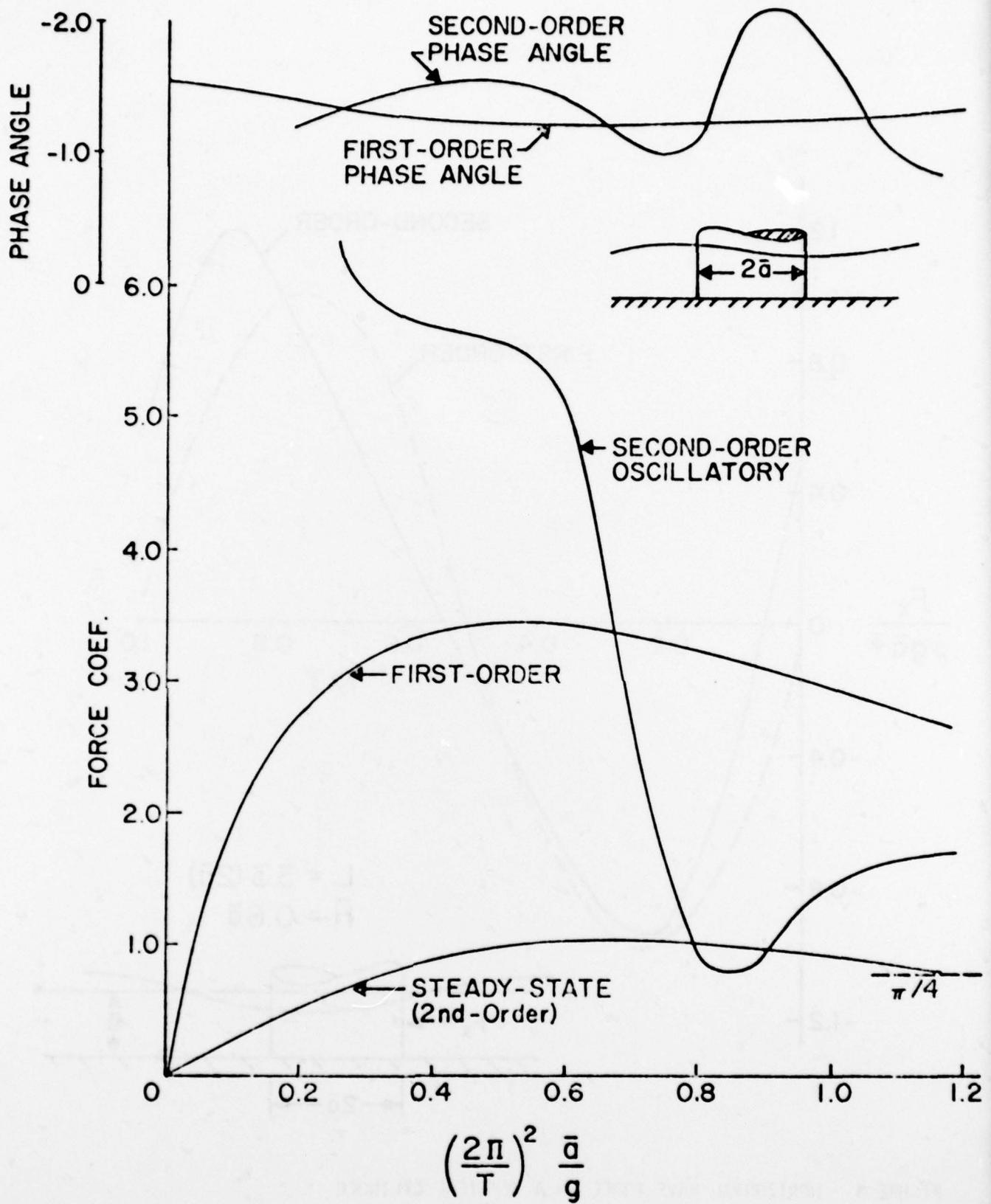
FIGURE 3 WAVE FORCE COEFFICIENTS FOR A VERTICAL CYLINDER
