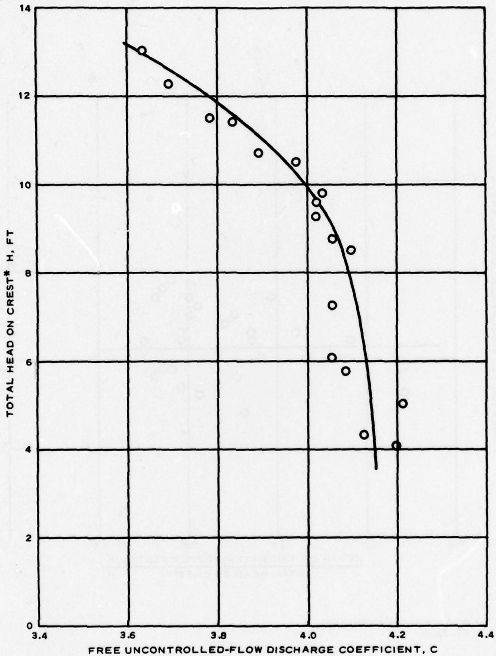
**DISCHARGE COEFFICIENT FOR FREE UNCONTROLLED FLOW**
