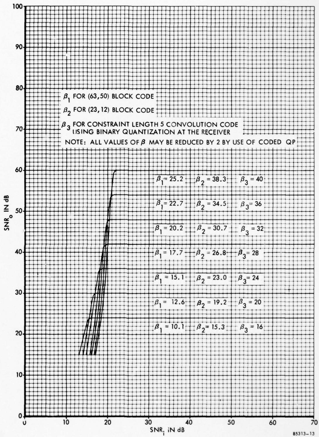
FIGURE 21 SNR<sub>o</sub> VS. SNR<sub>i</sub> FOR CODED PSK
