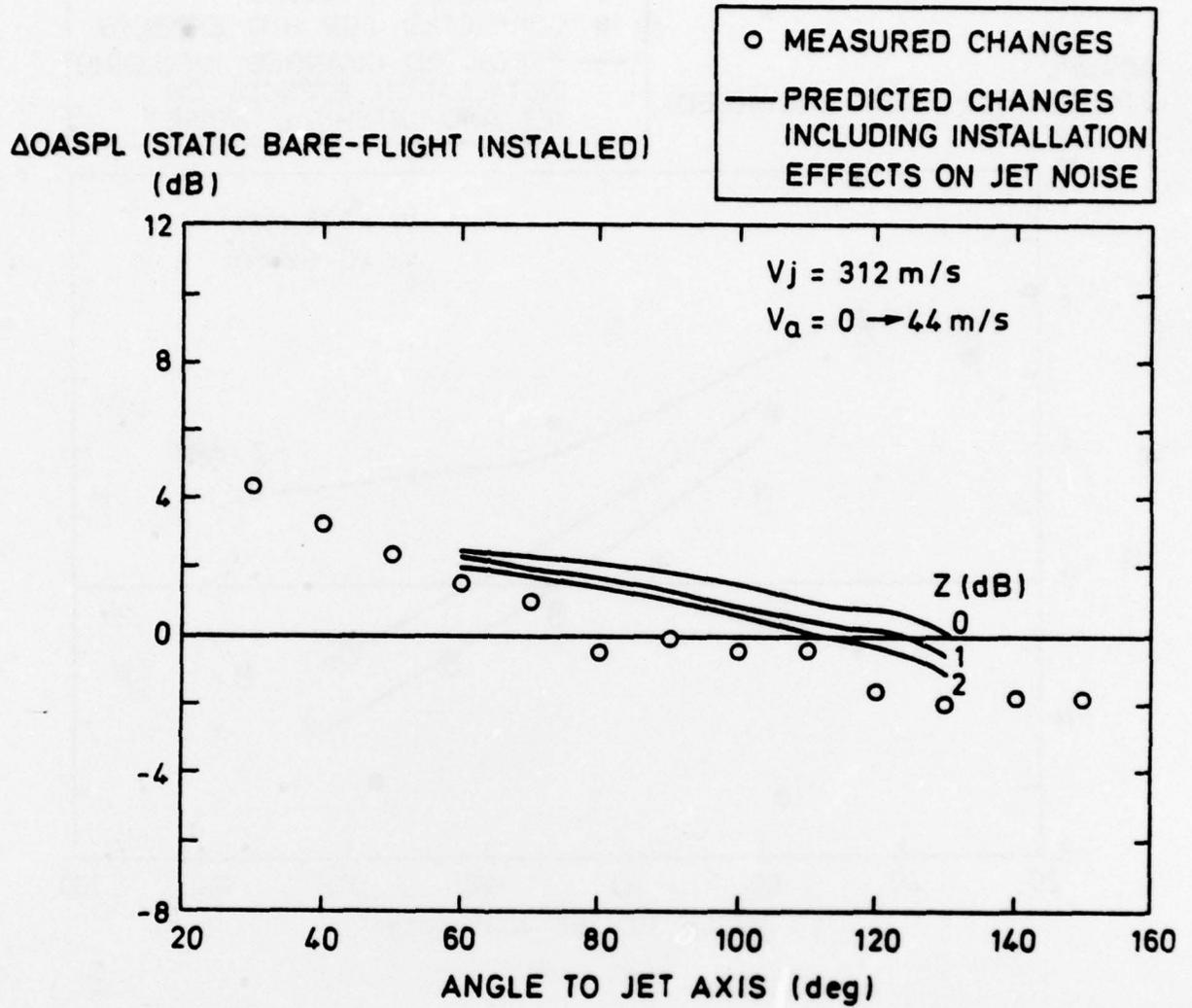
**FIG. 41 STATIC-TO-FLIGHT DATA FOR THE SPINNING RIG AT MAXIMUM DRAG**
