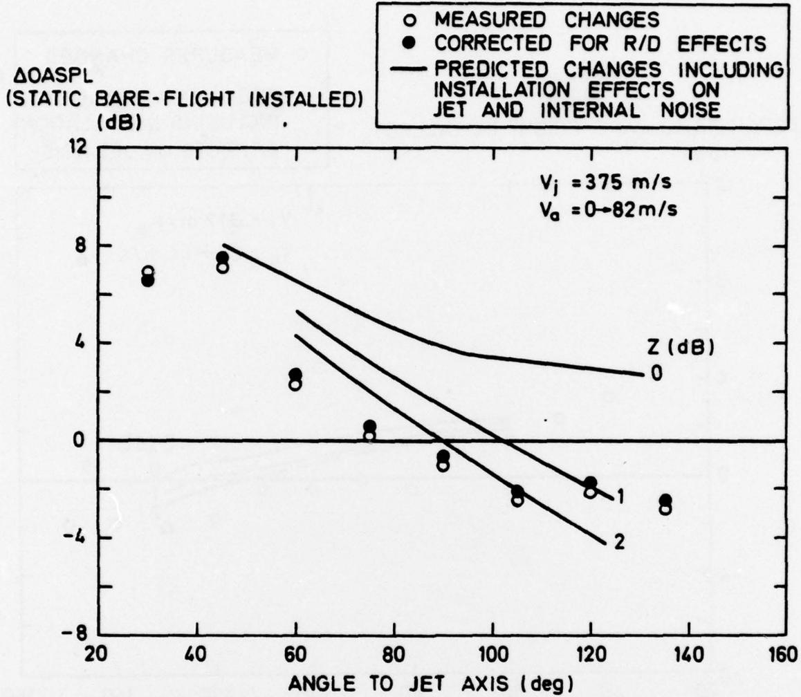
**FIG. 42 STATIC-TO-FLIGHT DATA FOR THE VIPER 601/HS125**
