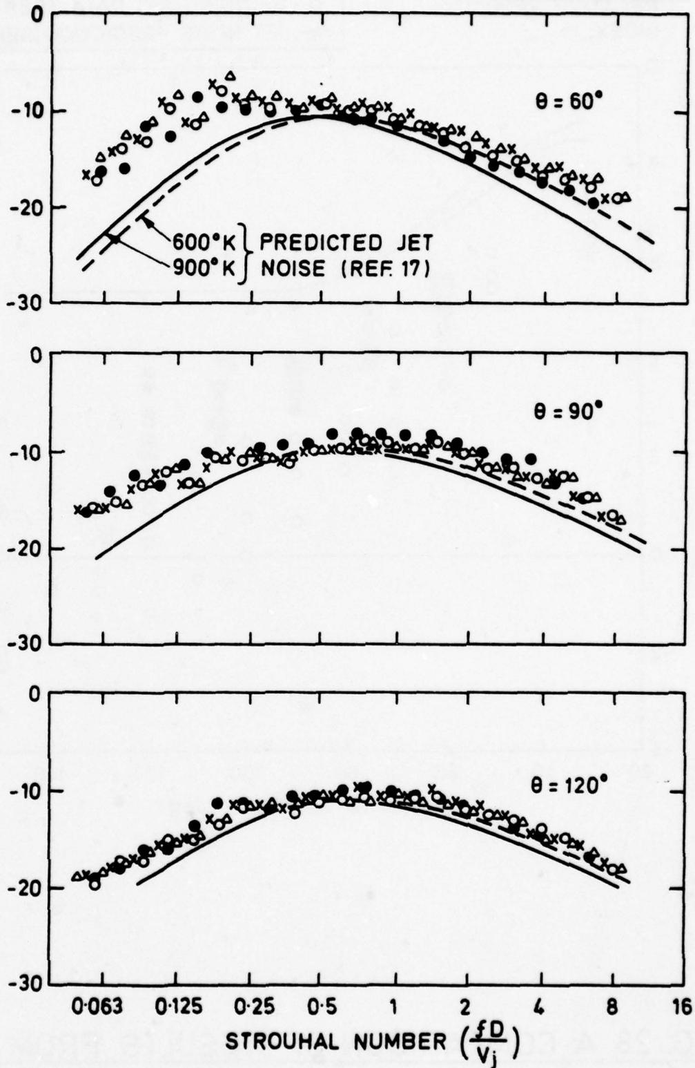
**FIG. 27 STATIC SPECTRA FROM THE SPINNING RIG SIMULATOR**
