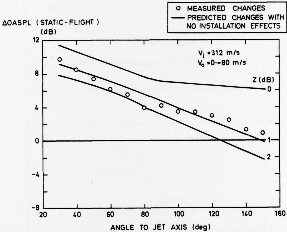
FIG. 40 STATIC-TO-FLIGHT DATA FOR THE SPINNING RIG AT MINIMUM DRAG
