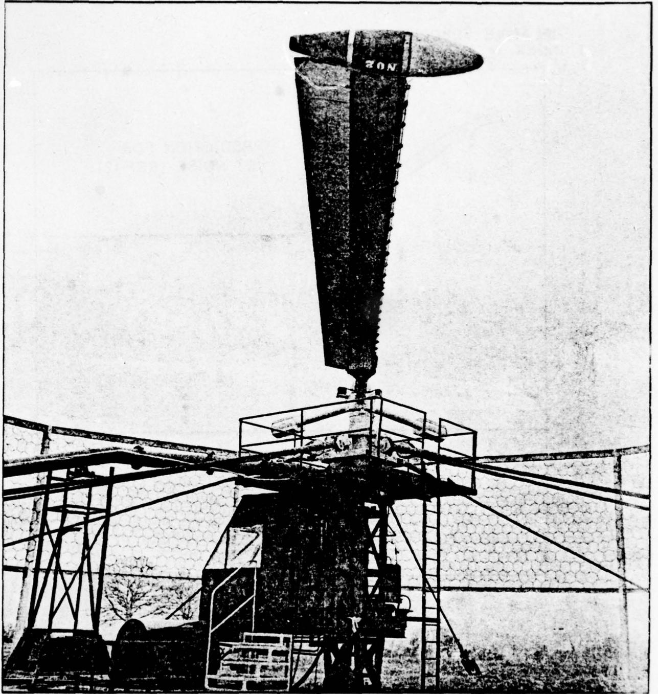
FIG.9 THE ROLLS-ROYCE SPINNING RIG
