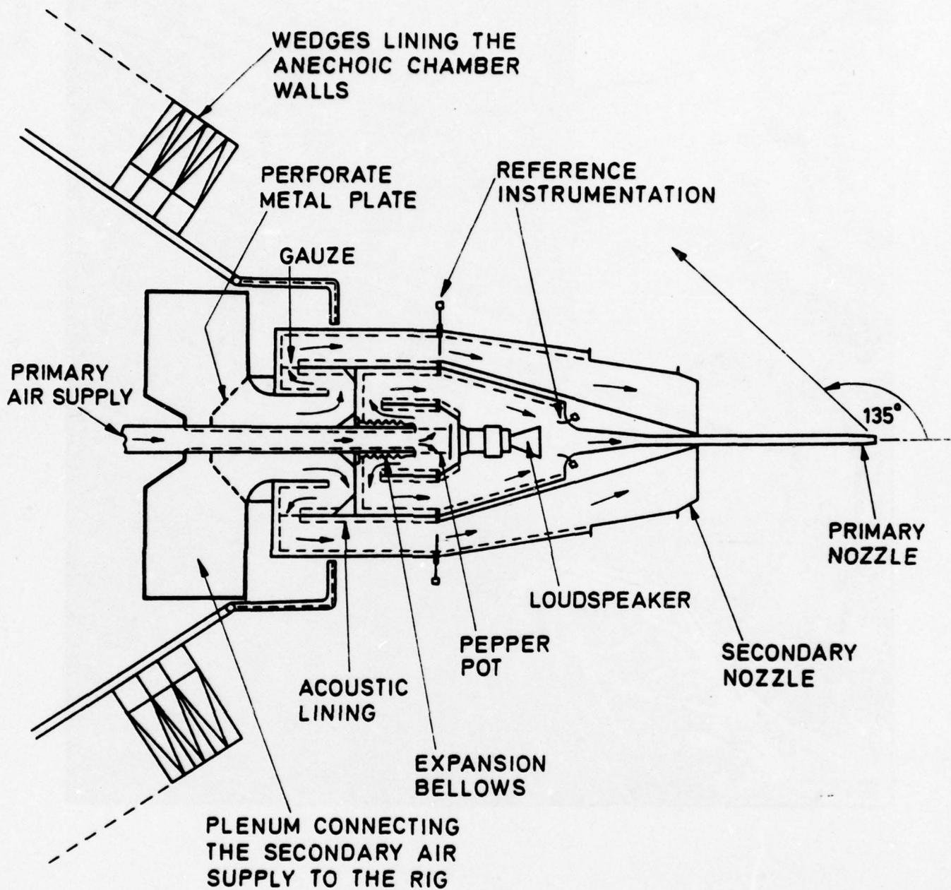
**FIG. 33 A CROSS-SECTION OF THE FLIGHT SIMULATION RIG (1976)**
