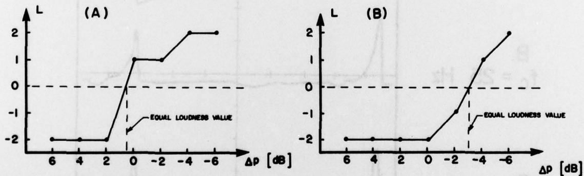
FIG. 15 RELATIVE LOUDNESS SCORES VS OVERPRESSURE RATIO BETWEEN REFERENCE AND TEST BOOM.
