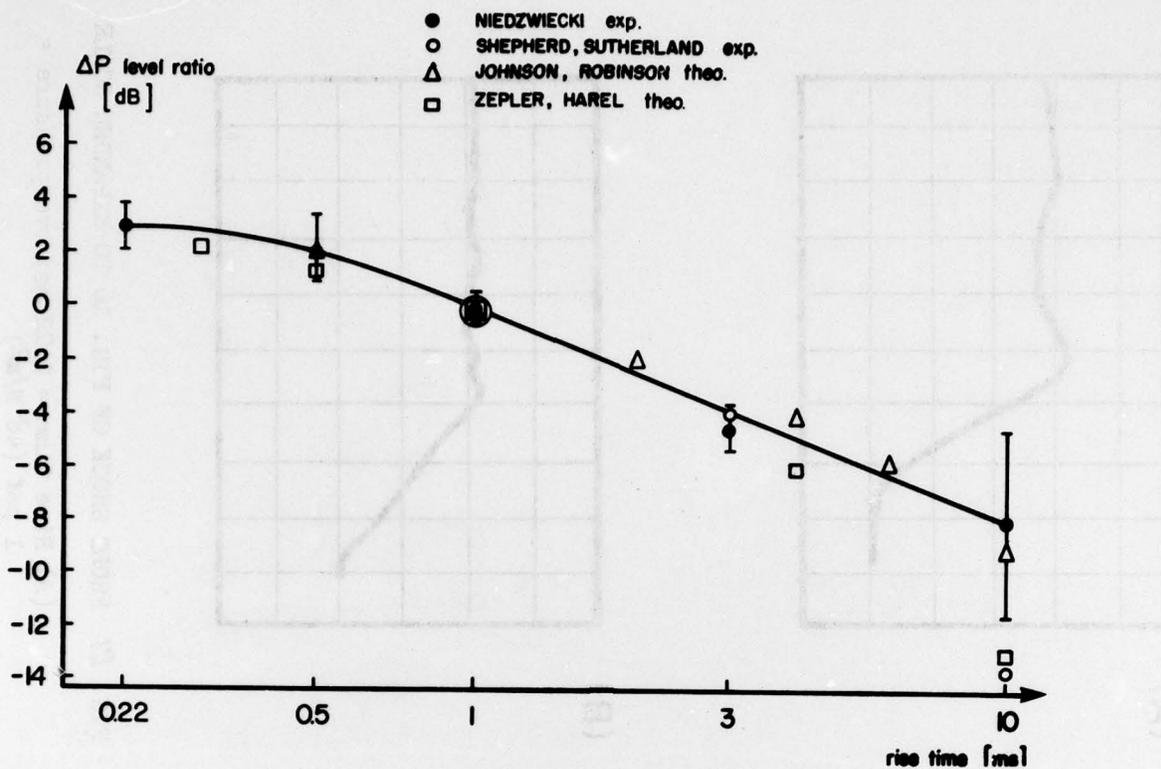
FIG. 18 EQUAL LOUDNESS CURVE. TRADE-OFF BETWEEN OVERPRESSURE LEVEL RATIO ( $-20 \log_{10} \Delta p_{\text{test}}/\Delta p_{\text{ref}}$ ) AND RISE TIME FOR 200 ms DURATION N-WAVES.
