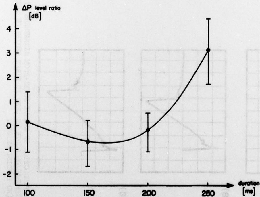
FIG. 19 EQUAL LOUDNESS CURVE. TRADE-OFF BETWEEN OVERPRESSURE LEVEL RATIO ( $-20 \log_{10} \Delta p_{\text{test}}/\Delta p_{\text{ref}}$ ) AND DURATION FOR 1 ms RISE TIME N-WAVE.
