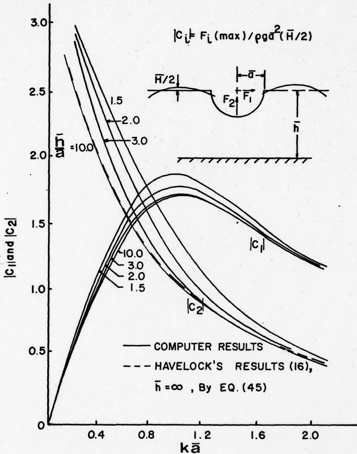
FIGURE 24 WAVE EXCITATION FORCES ON A SEMI-SUBMERGED SPHERE
