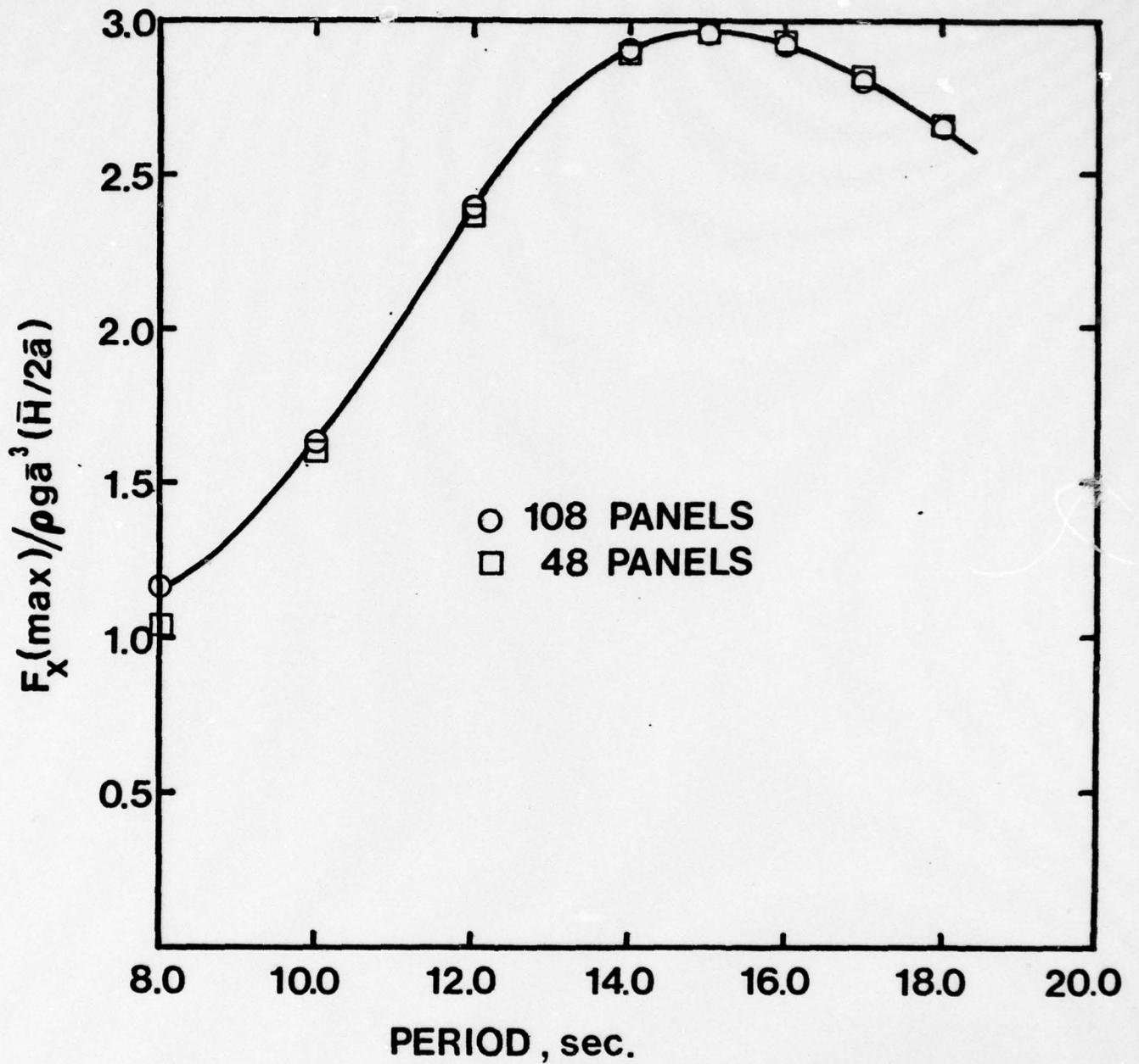
FIGURE 12 HORIZONTAL FORCE COEFFICIENT
