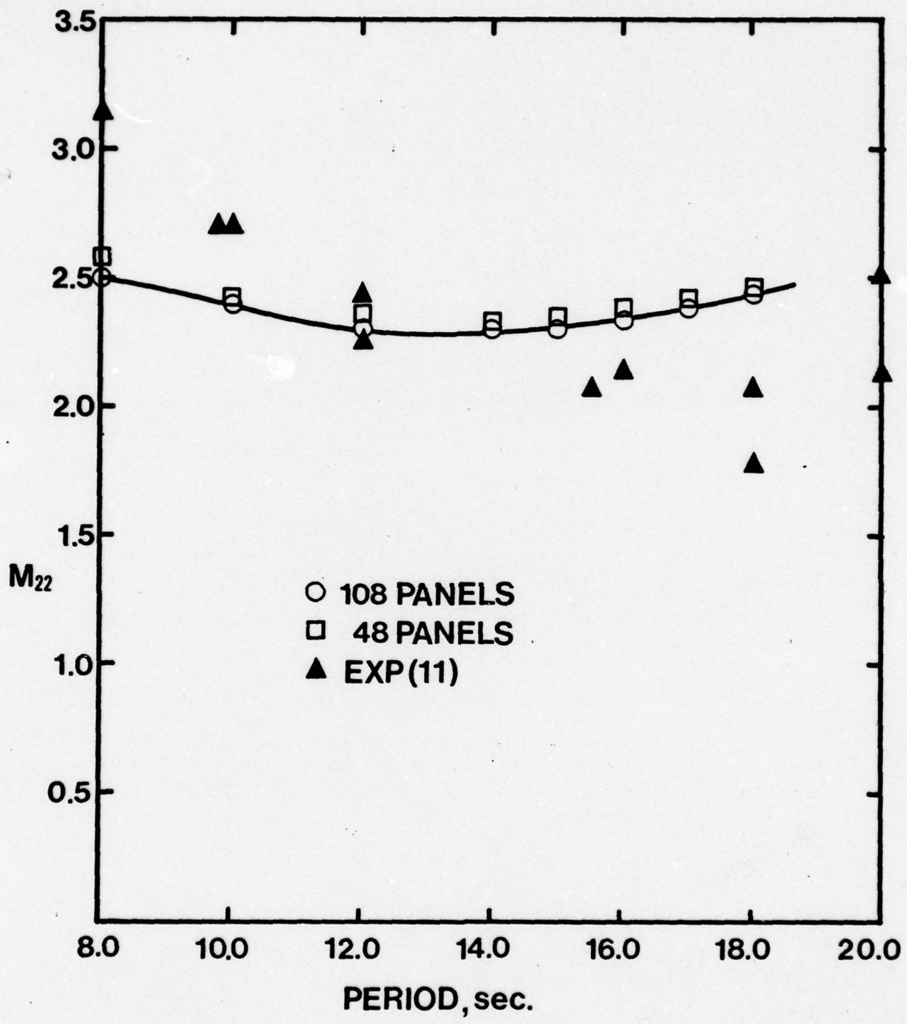
FIGURE 16 HEAVE ADDED MASS COEFFICIENT
