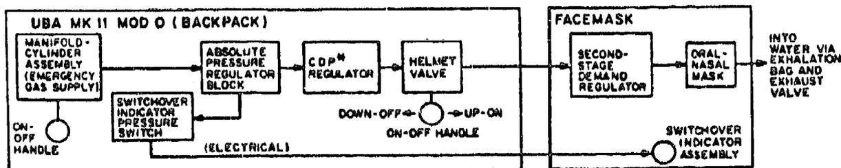
D. OPEN - CIRCUIT, EMERGENCY MANIFOLD - SUPPLIED OPERATION
