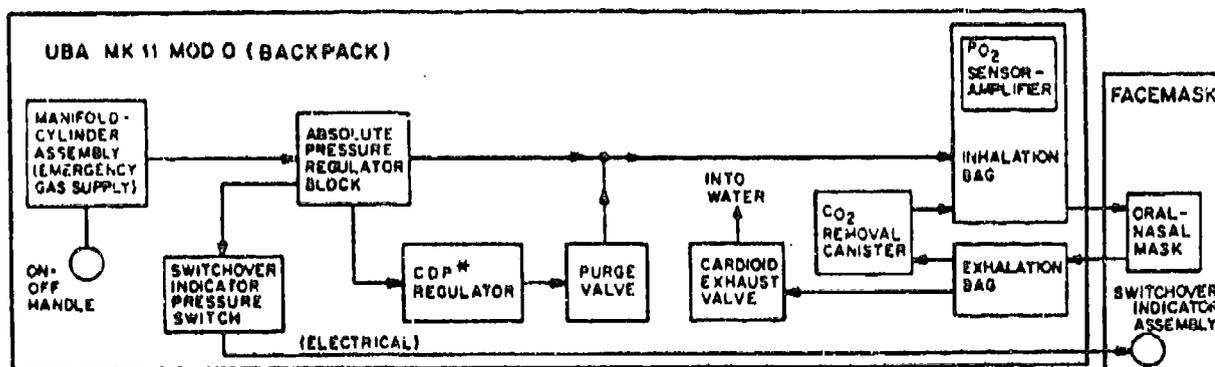
B. SEMICLOSED - CIRCUIT, EMERGENCY MANIFOLD - SUPPLIED OPERATION
