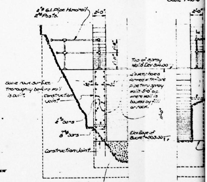
**TYPICAL DETAIL OF CONSTRUCTION JOINT
